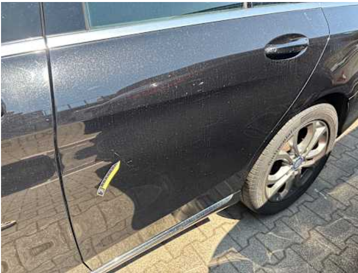
Türe hinten links (Kratzer, Lackschaden)
