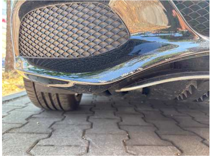
Stoßstange vorne (Kratzer, Lackschaden)
