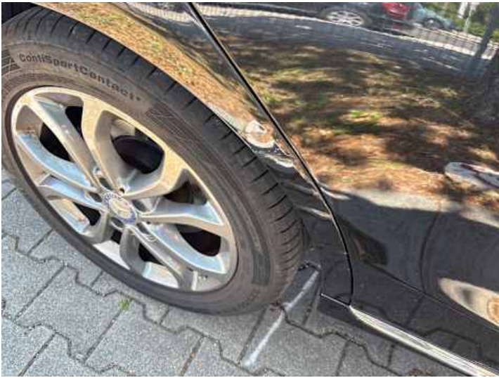
Seitenteil hinten rechts (Verformung, Delle, Kratzer, Lackschaden, Unsachgemäß instand gesetzt)
