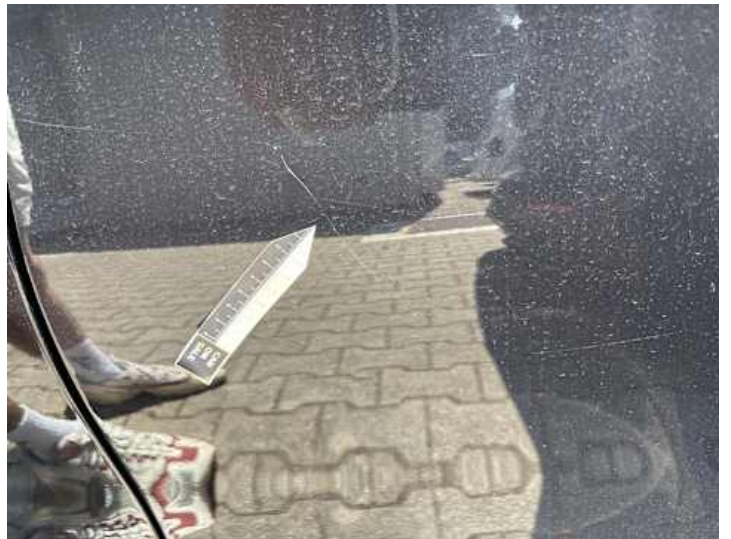
Türe hinten links (Kratzer, Lackschaden)
