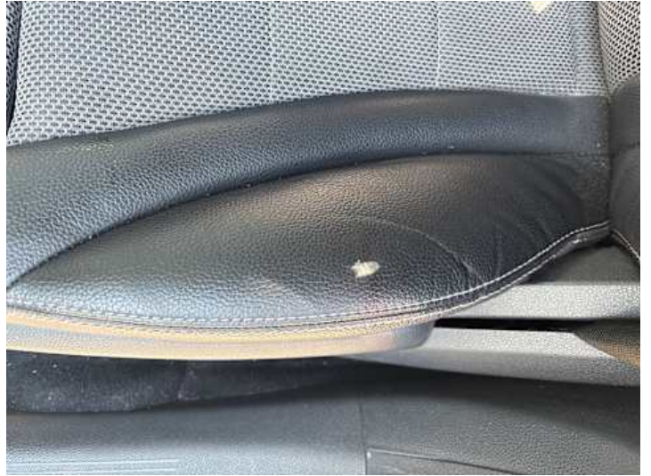
Innenraum (Riss/Bruch, Kratzer)
