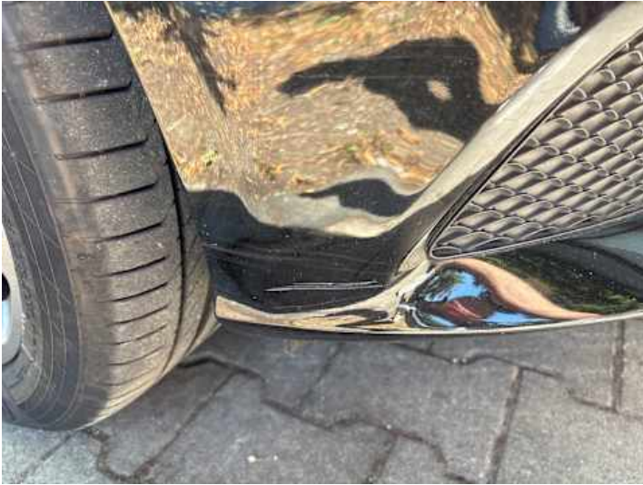
Stoßstange vorne (Kratzer, Lackschaden)
