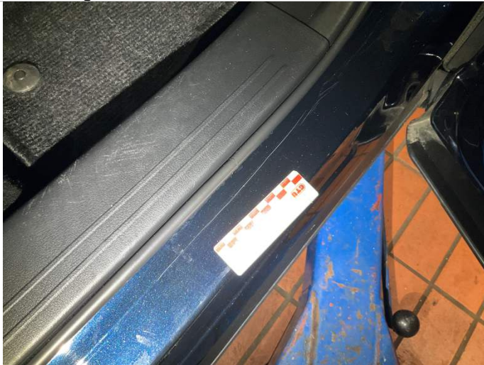
Einstiegsschweller vorne rechts Kratzer
