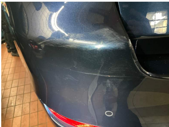
Stoßfänger hinten links Streifschusses Detailbild
