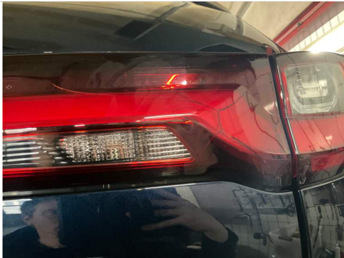
Rücklicht hinten rechts innen beschädigt
