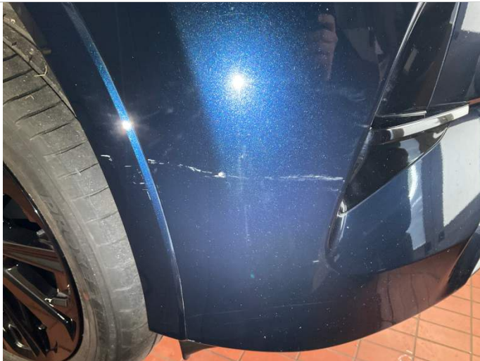
Stoßfänger vorne rechts Lackbeschädigung
