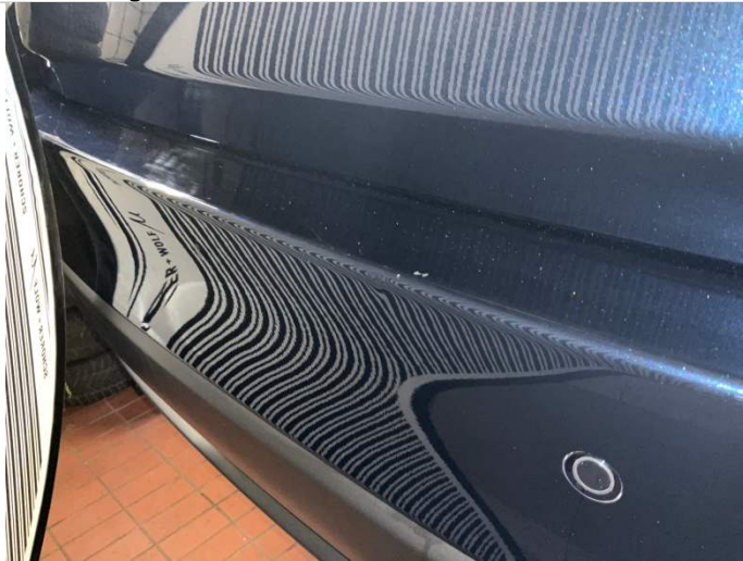
Stoßfänger hinten verformt
