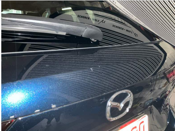
Heckklappe Delle mit Lackbeschädigung
