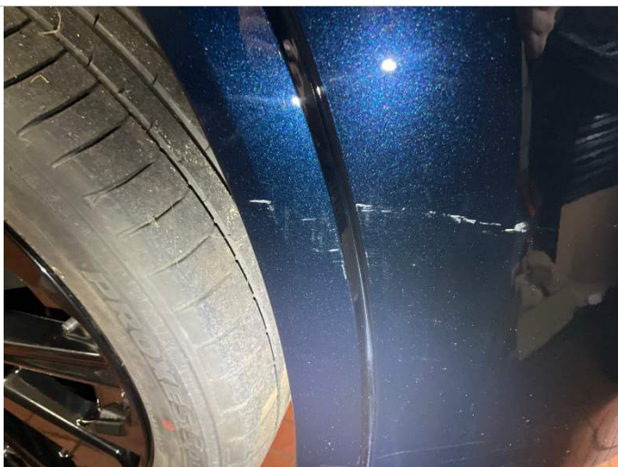
Radlaufblende vorne rechts Lackbeschädigung
