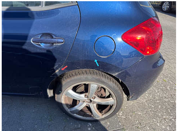
Seitenteil hinten links (Kratzer, Rost)
