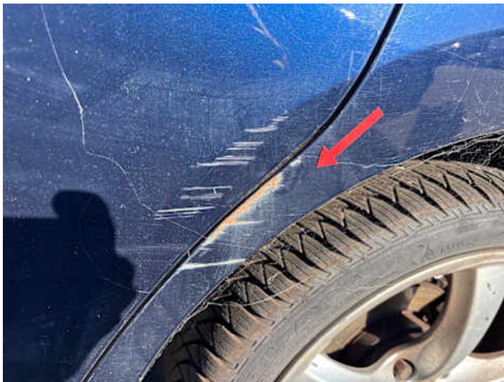
Seitenteil hinten links (Kratzer, Rost)
