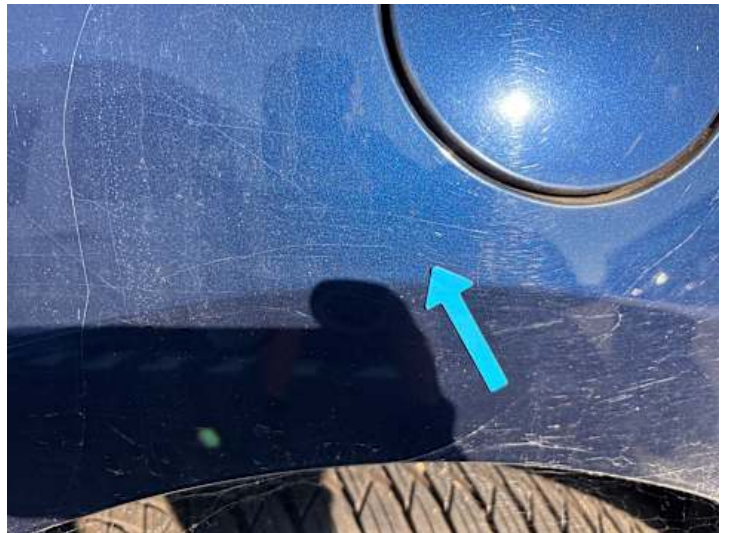
Seitenteil hinten links (Kratzer, Rost)
