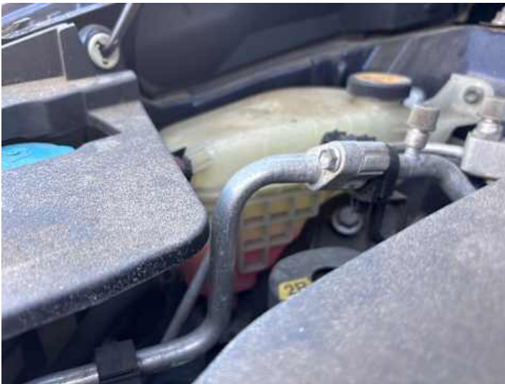
Motorhaube (Anderer Schaden): Kühlmittelstand zu gering,
