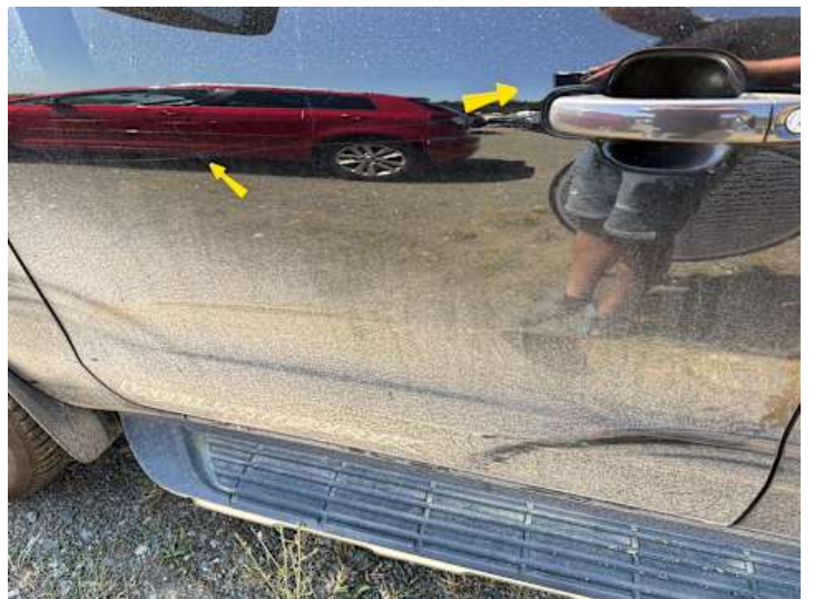
Fahrtür (Delle, Kratzer)
