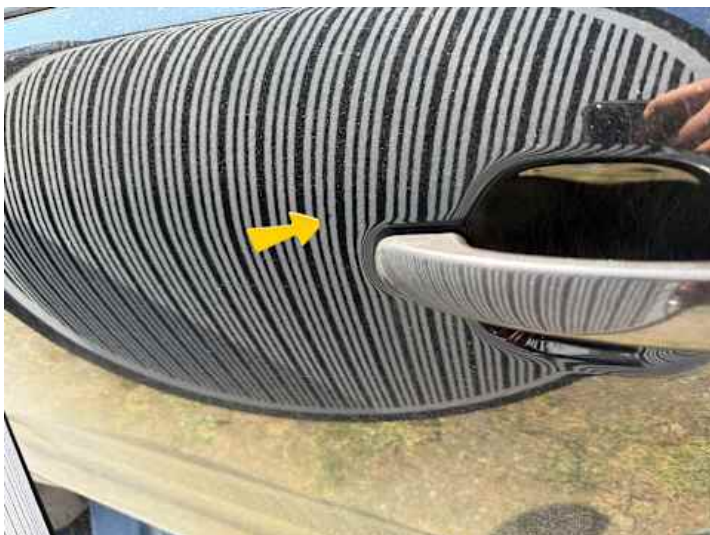
Fahrtür (Delle, Kratzer)
