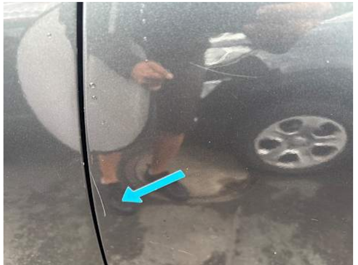
Türe hinten links (Kratzer)
