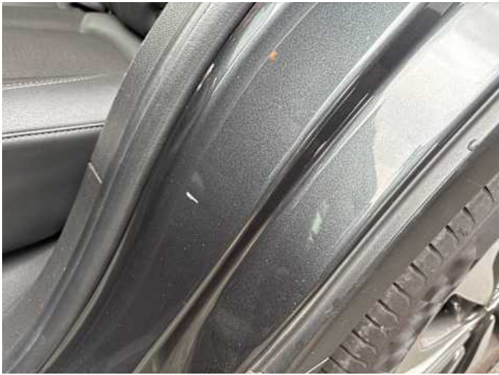
Seitenteil hinten links (Lackschaden)
