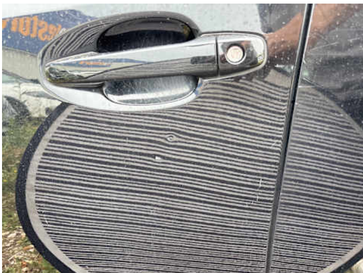
Fahrtür (Delle, Kratzer)
