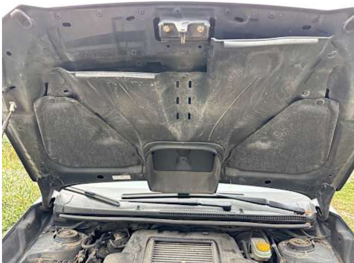
Motorhaube (Anderer Schaden): Innenverkleidung locker
