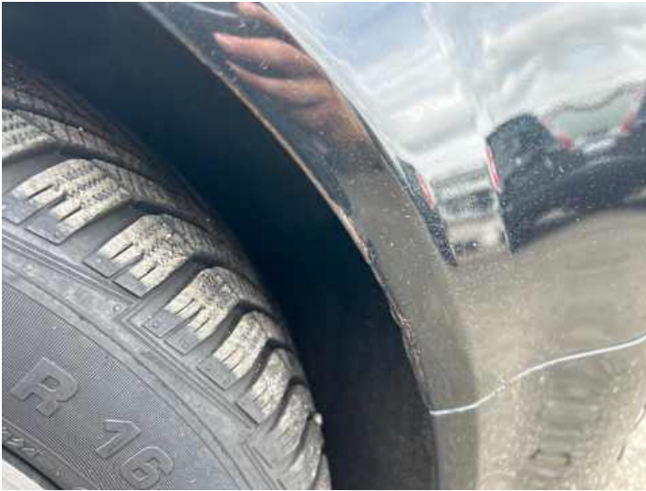
Kotflügel vorne rechts (Lackschaden, Rost, Unsachgemäß instand gesetzt)
