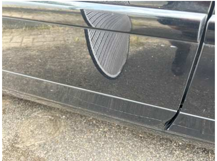
Türe hinten rechts (Kratzer, Delle)
