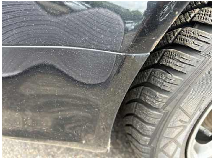
Stoßstange vorne (Lackschaden, Kratzer, Riss/Bruch)
