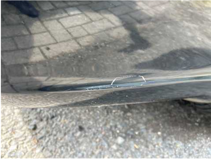
Stoßstange hinten (Lackschaden, Kratzer, Verformung)
