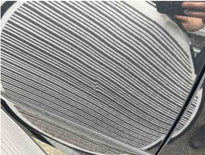
Türe hinten rechts (Kratzer, Delle)
