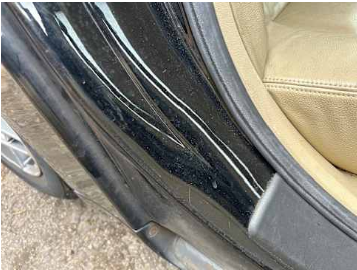
Türe hinten rechts (Kratzer, Delle)
