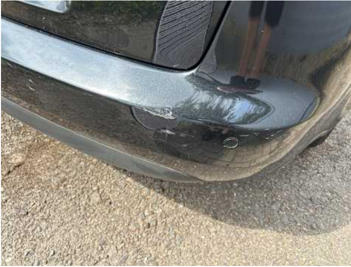
Stoßstange hinten (Lackschaden, Kratzer, Verformung)
