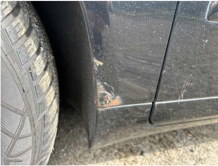
Kotflügel vorne links (Rost, Kratzer)
