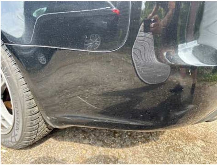
Stoßstange hinten (Lackschaden, Kratzer, Verformung)
