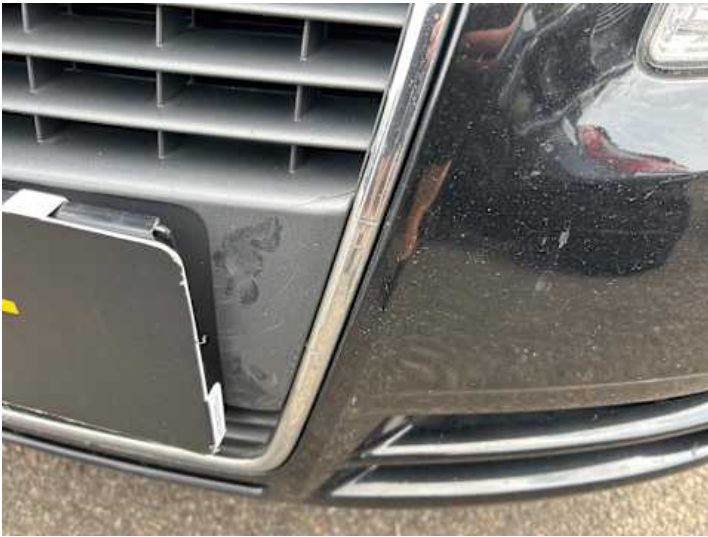
Stoßstange vorne (Lackschaden, Kratzer, Riss/Bruch)
