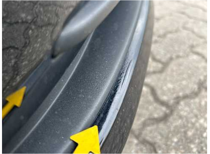
Stoßstange vorne (Unsachgemäß instand gesetzt)
