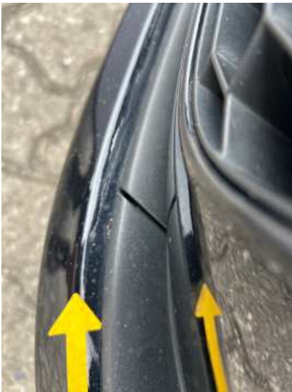
Stoßstange vorne (Unsachgemäß instand gesetzt)
