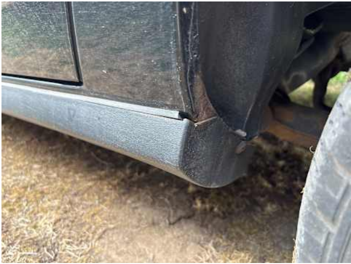
Schweller links (Rost)
