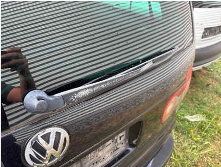
Rückscheibe (Anderer Schaden): Lackschaden
