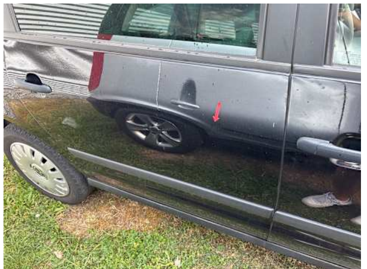
Türe hinten rechts (Delle)
