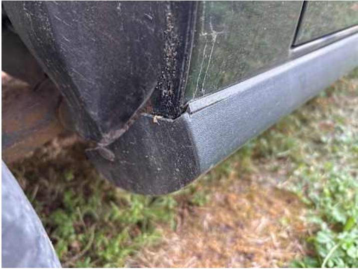
Schweller rechts (Rost)
