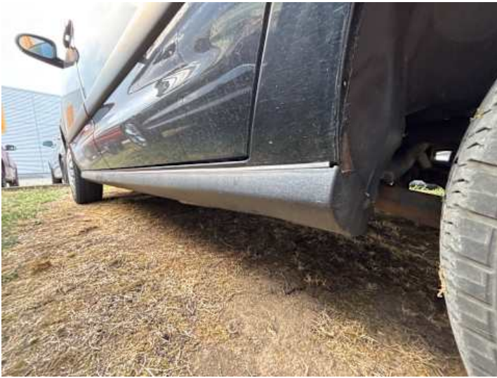
Schweller links (Rost)
