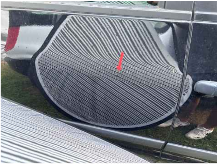
Türe hinten rechts (Delle)
