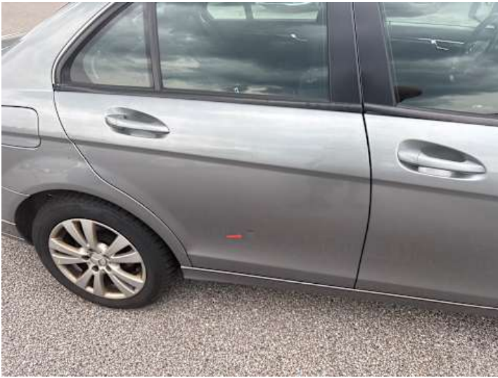
Türe hinten rechts (Lackschaden, Unsachgemäß instand gesetzt, Verformung)
