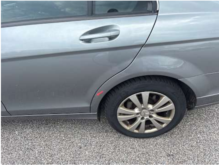
Seitenteil hinten links (Rost, Lackschaden)
