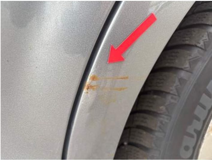
Seitenteil hinten links (Rost, Lackschaden)
