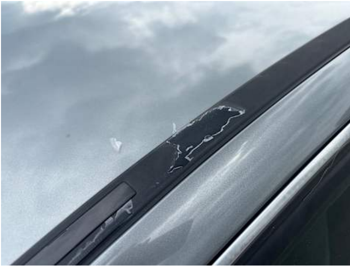
Dach (Lackschaden, Ausgeblichen/Matt)
