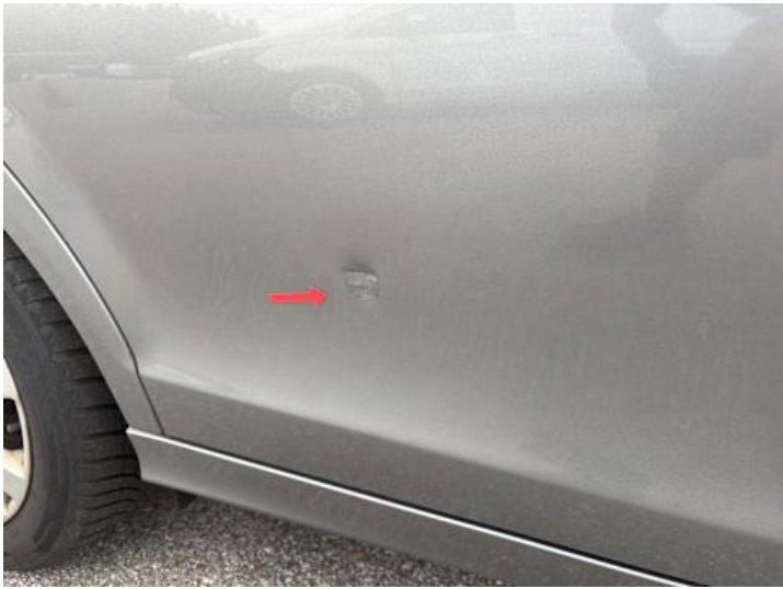
Türe hinten rechts (Lackschaden, Unsachgemäß instand gesetzt, Verformung)
