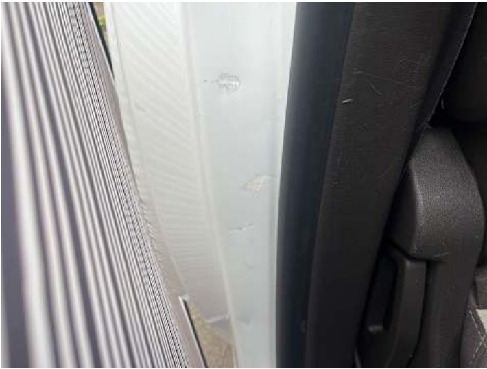
Türe hinten rechts (Delle, Lackschaden, Unsachgemäß instand gesetzt)
