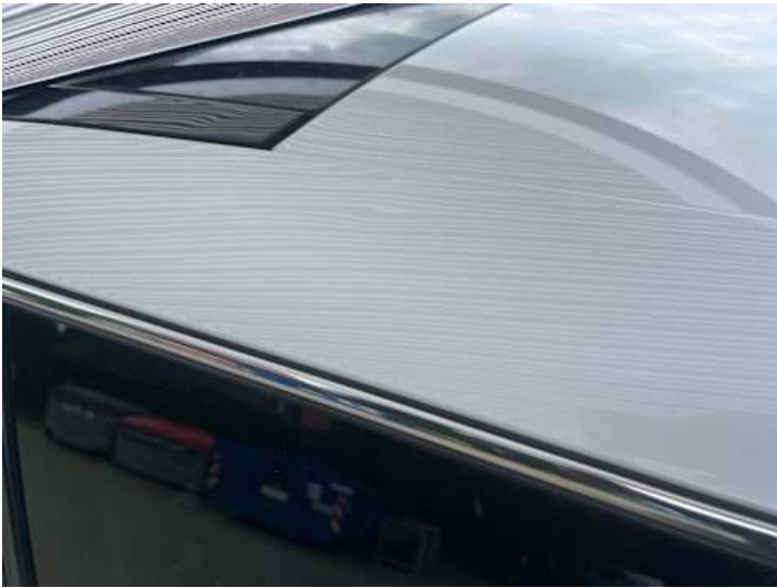
Seitenteil hinten links (Delle)
