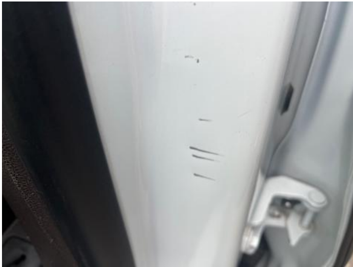
Fahrtür (Kratzer, Lackschaden, Delle)
