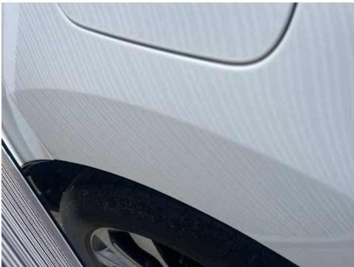
Seitenteil hinten rechts (Delle)
