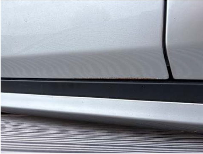
Fahrtür (Rost, Delle, Kratzer)
