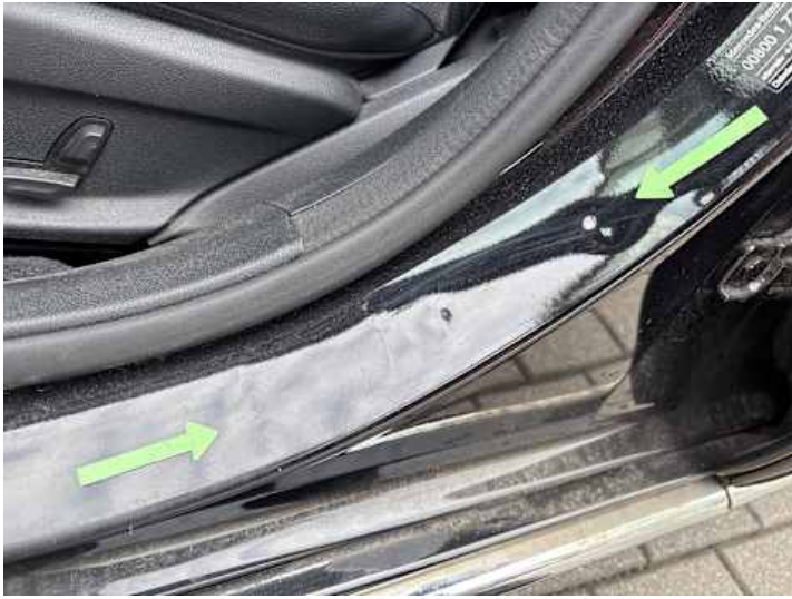
Schweller links (Delle, Lackschaden)
