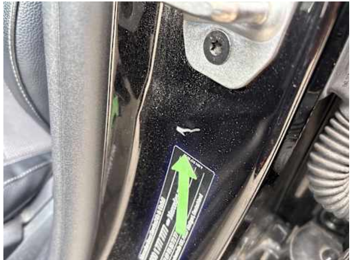
Fahrtür (Kratzer, Lackschaden)
