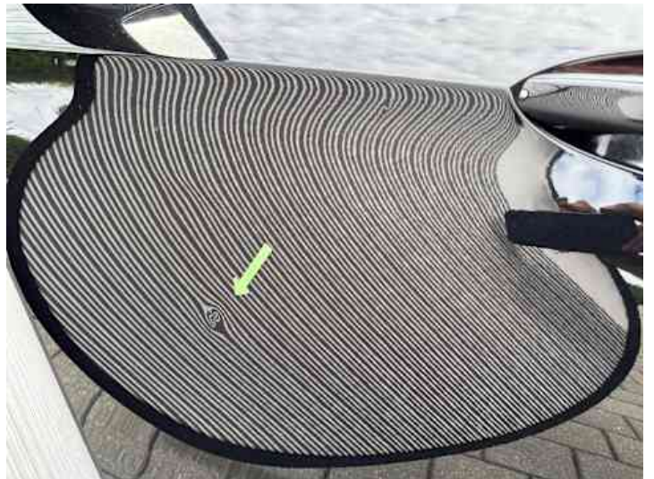
Fahrtür (Delle, Lackschaden)
