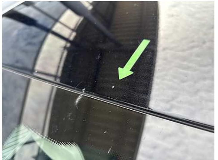
Dach (Steinschlag, Lackschaden)
