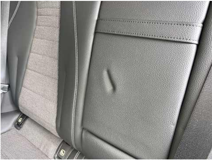
Innenraum (Anderer Schaden): Druckstellen
