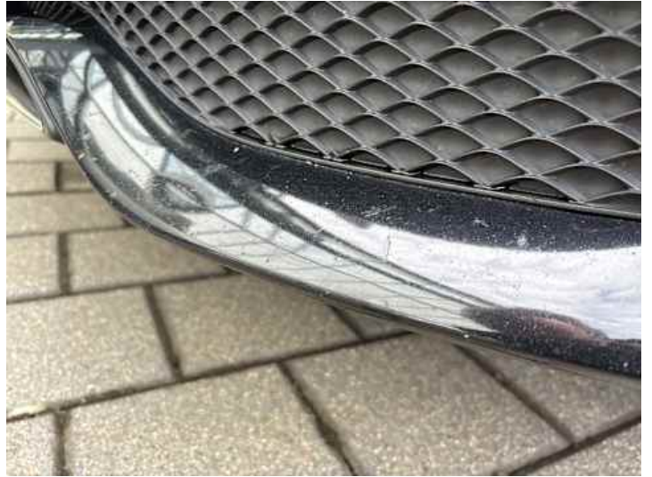
Stoßstange vorne (Steinschlag, Lackschaden)
