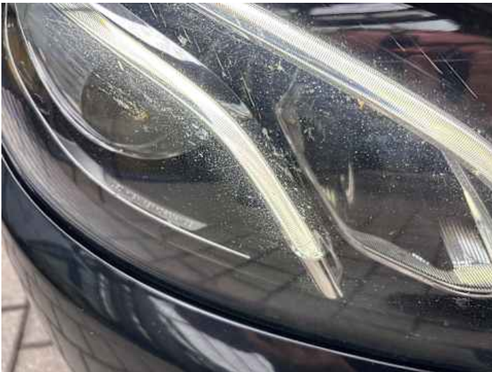
Scheinwerfer (rechts) (Steinschlag)
