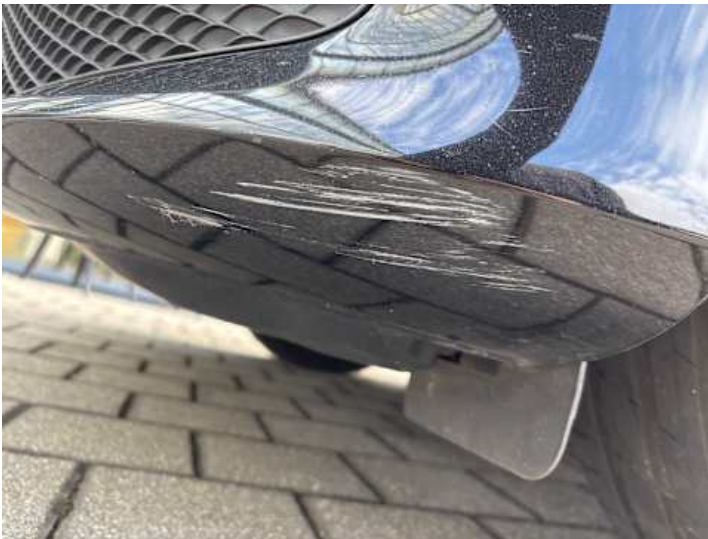
Stoßstange vorne (Kratzer, Lackschaden)
