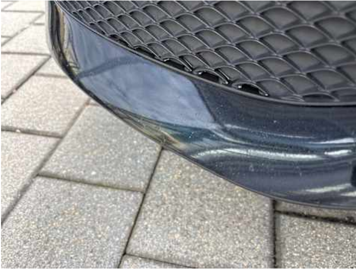
Stoßstange vorne (Steinschlag, Lackschaden)
