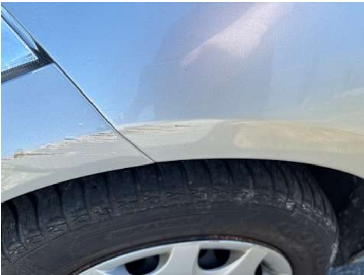
Kotflügel vorne links (Kratzer)
