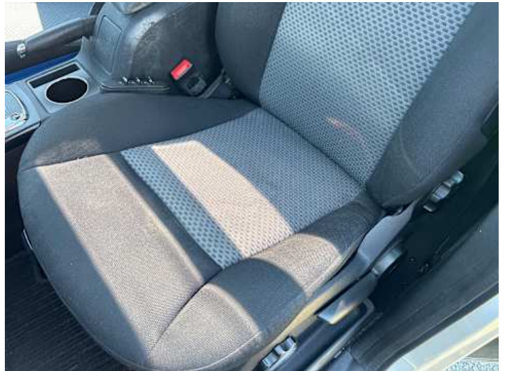
Innenraum (Verschmutzung, Verschleiß)
