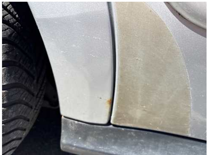
Schweller rechts (Rost)
