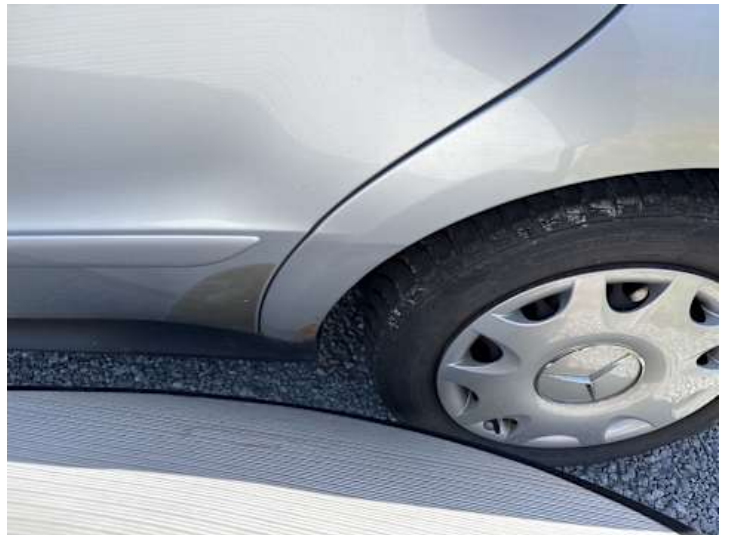
Seitenteil hinten links (Verformung, Unsachgemäß instand gesetzt)
