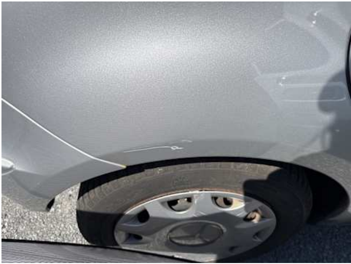
Seitenteil hinten rechts (Verformung, Kratzer)
