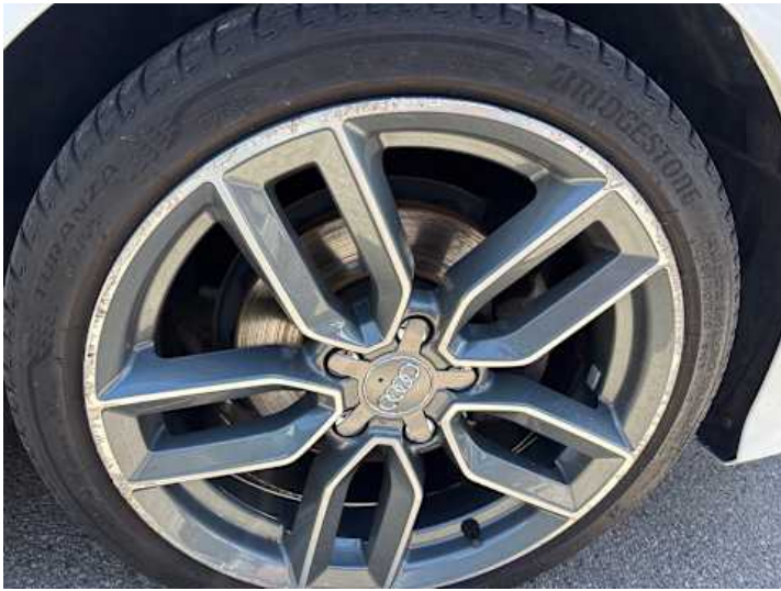
Rad (Kratzer, Kerben, Riss/Bruch)
