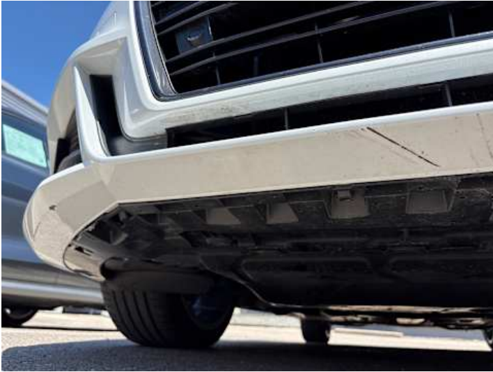
Stoßstange vorne (Unsachgemäß instand gesetzt, Lackschaden, Kratzer)
