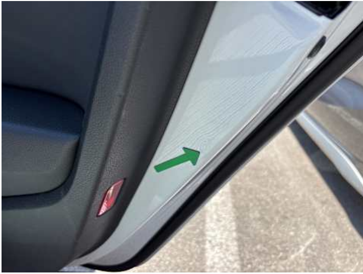
Türe hinten rechts (Delle, Lackschaden)
