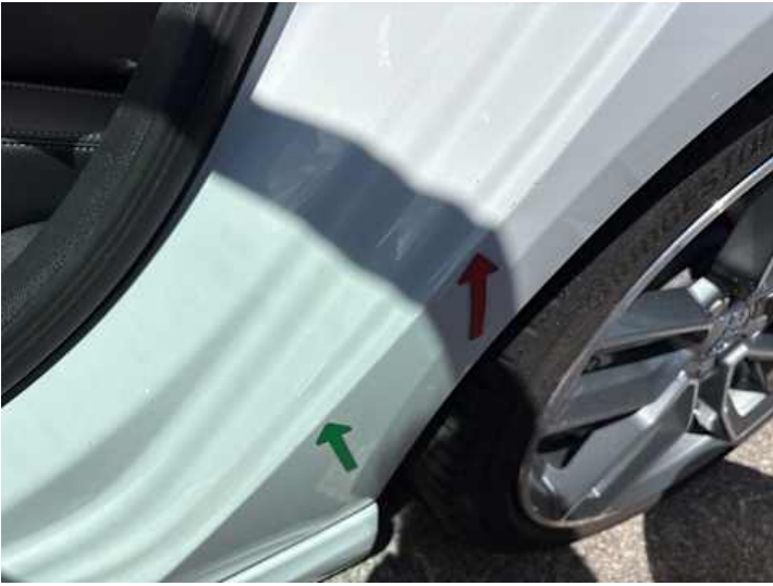
Seitenteil hinten links (Lackschaden, Unsachgemäß instand gesetzt)
