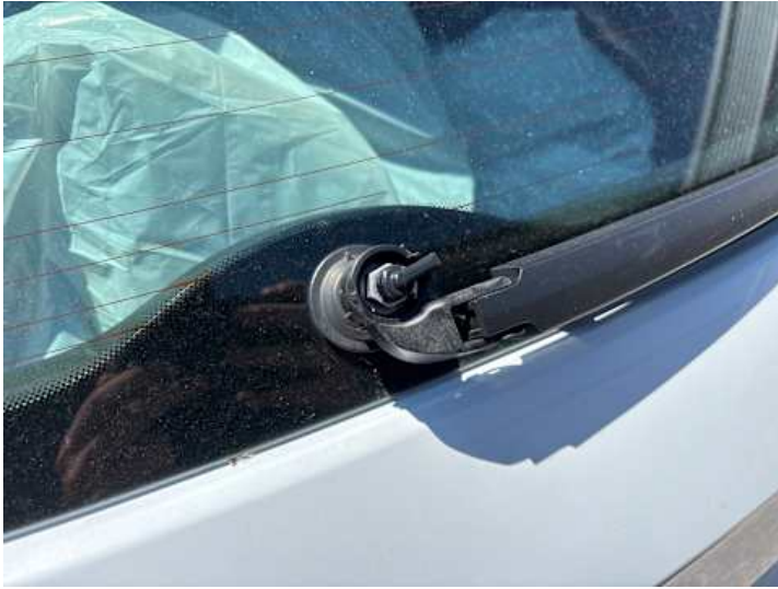
Rückscheibe (Anderer Schaden): Abdeckung fehlt
