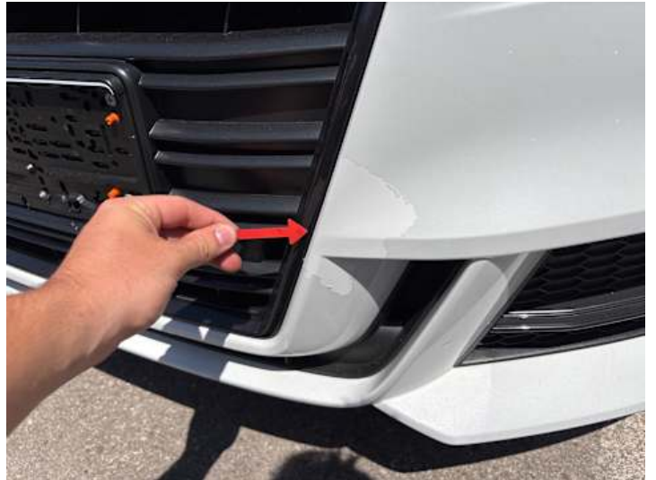
Stoßstange vorne (Unsachgemäß instand gesetzt, Lackschaden, Kratzer)
