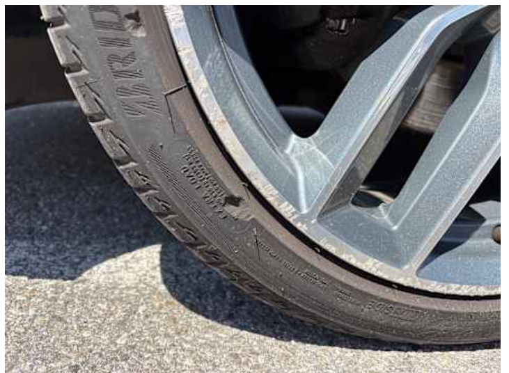
Rad (Kerben, Kratzer, Riss/Bruch)
