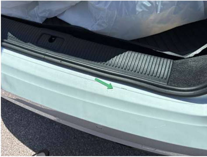
Stoßstange hinten (Kratzer, Lackschaden, Unsachgemäß instand gesetzt)
