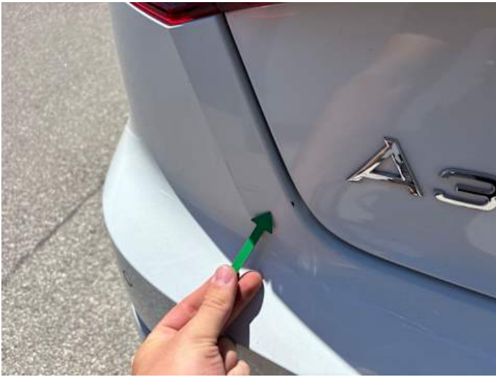
Stoßstange hinten (Kratzer, Lackschaden, Unsachgemäß instand gesetzt)
