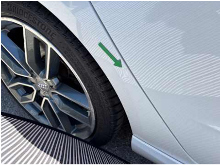
Seitenteil hinten rechts (Kratzer, Lackschaden, Delle, Unsachgemäß instand gesetzt)
