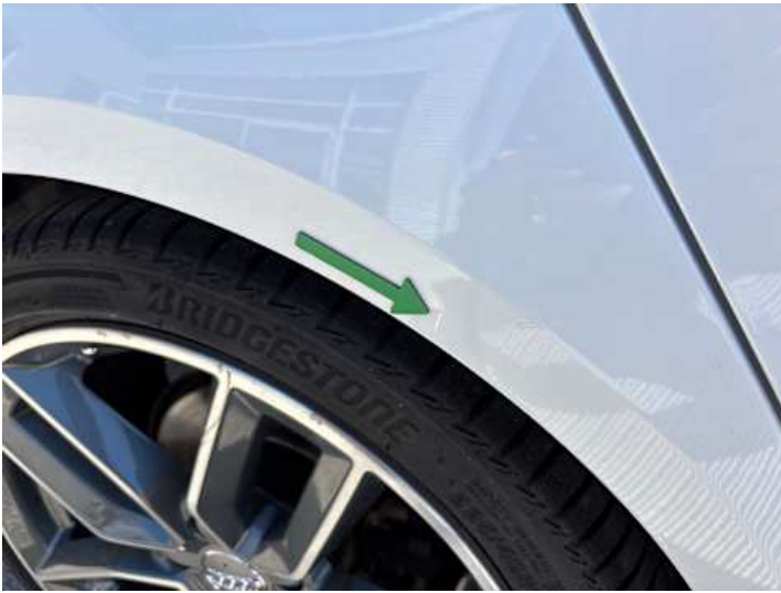
Seitenteil hinten rechts (Kratzer, Lackschaden, Delle, Unsachgemäß instand gesetzt)
