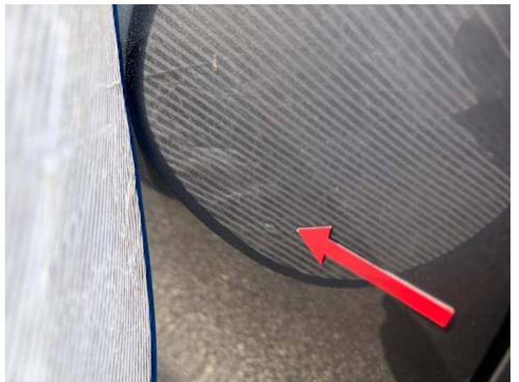
Türe hinten rechts (Delle, Lackschaden)
