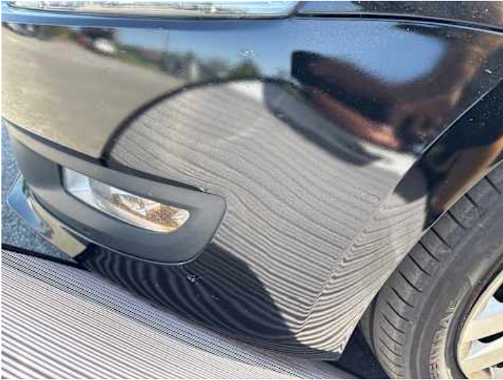
Stoßstange vorne (Lackschaden, Unsachgemäß instand gesetzt)
