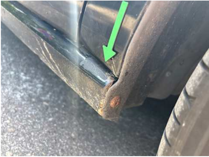
Schweller rechts (Rost)
