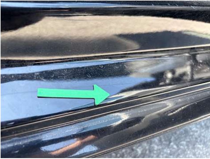
Schweller rechts (Rost)
