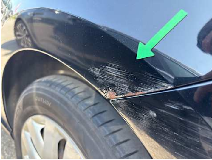
Seitenteil hinten links (Rost)
