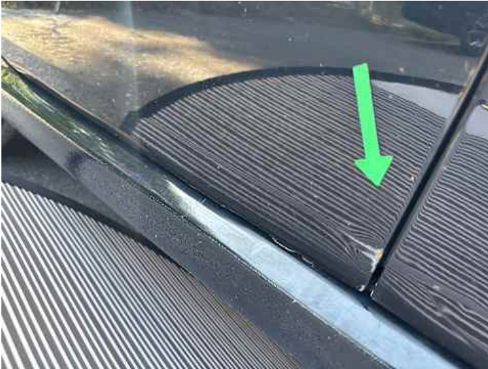
Türe hinten rechts (Kratzer, Verformung, Rost)
