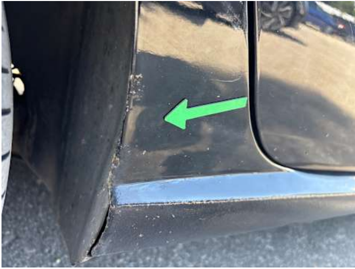
Seitenteil hinten rechts (Rost)
