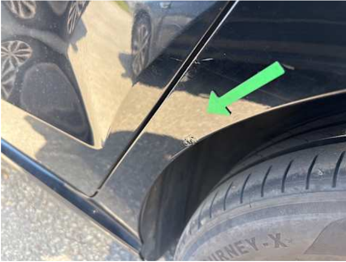
Seitenteil hinten links (Rost)
