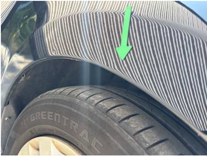
Kotflügel vorne rechts (Rost, Verformung)
