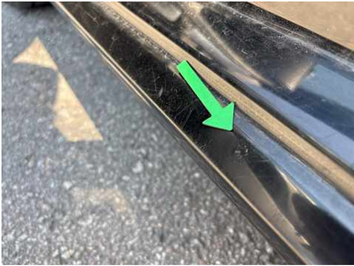
Schweller links (Rost)
