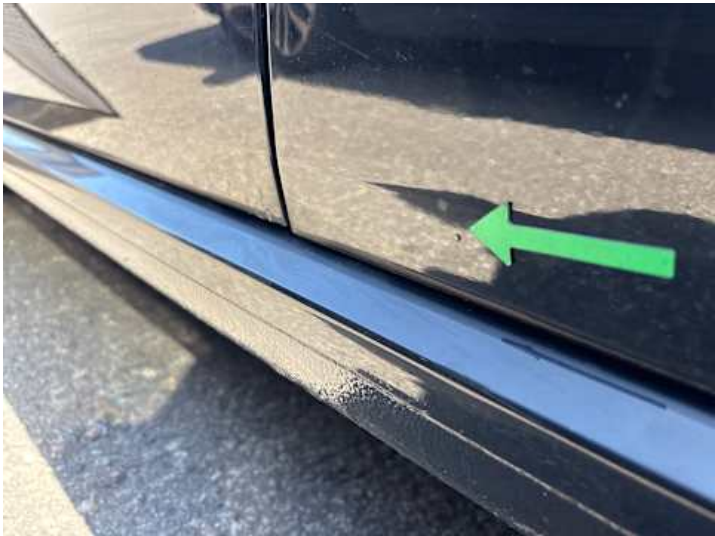
Türe hinten links (Rost)
