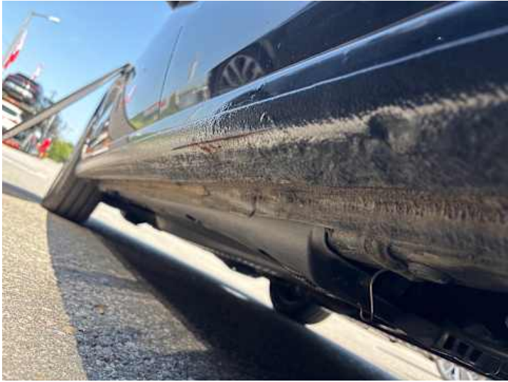
Schweller rechts (Rost)
