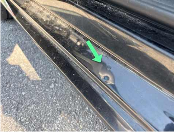
Schweller links (Delle)
