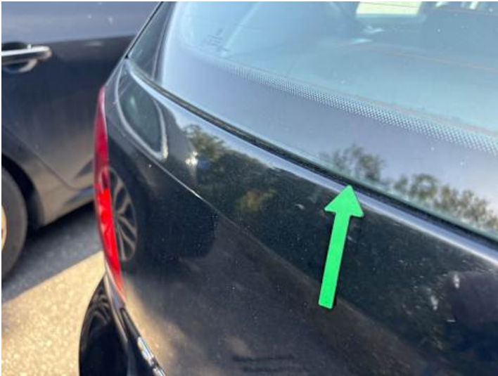
Rückscheibe (Anderer Schaden): Ablösung
