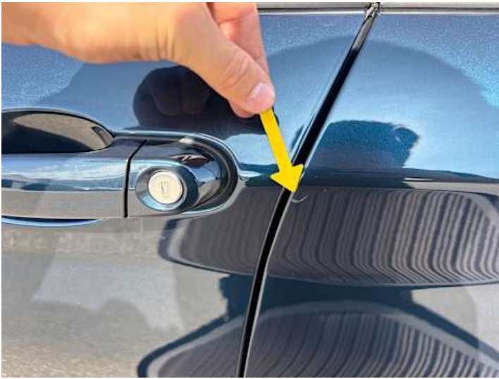
Türe hinten links (Kratzer, Lackschaden, Delle)
