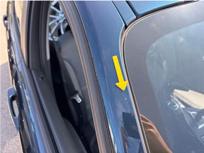
Seitenteil hinten rechts (Steinschlag)
