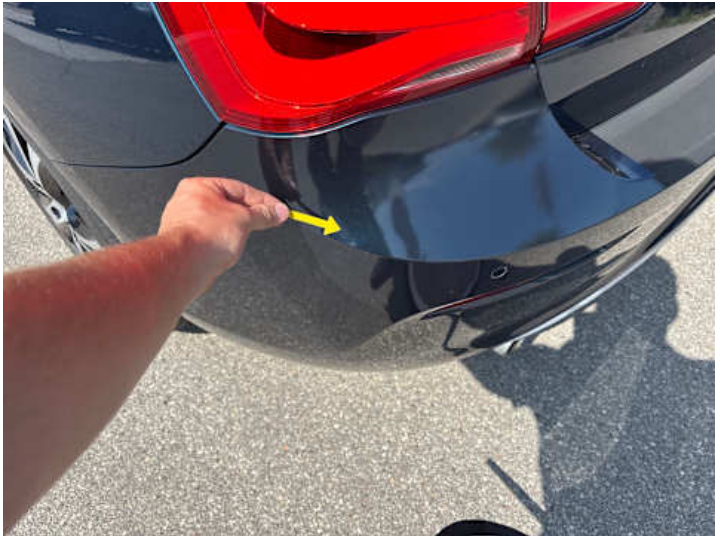
Stoßstange hinten (Unsachgemäß instand gesetzt, Lackschaden, Ausgeblichen/Matt, Riss/Bruch)
