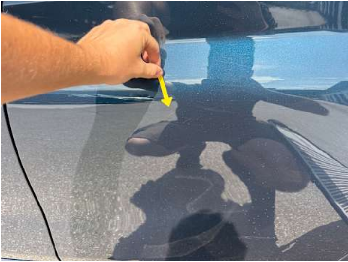
Türe hinten links (Kratzer, Lackschaden, Delle)
