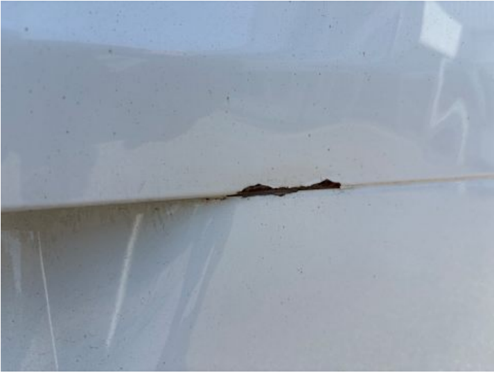
Heckklappe (Kratzer, Rost, Delle)
