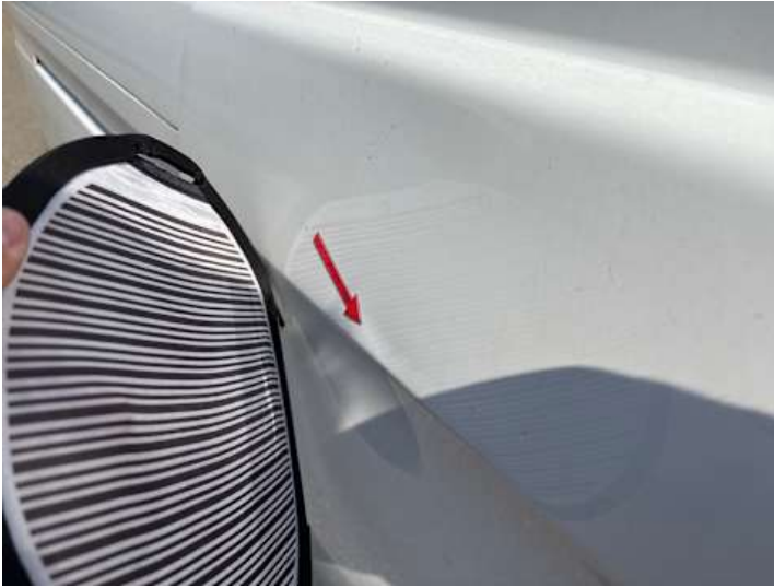
Türe hinten rechts (Anderer Schaden, Delle): Defekt
