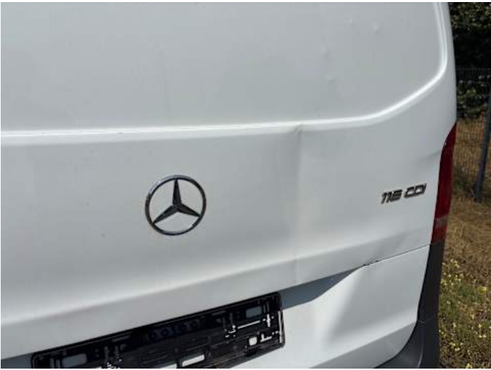
Heckklappe (Kratzer, Rost, Delle)
