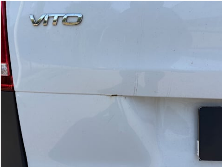
Heckklappe (Kratzer, Rost, Delle)
