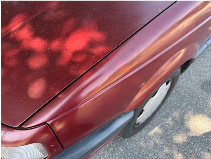
Kotflügel vorne links (Unsachgemäß instand gesetzt)
