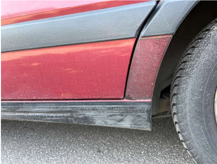
Schweller links (Unsachgemäß instand gesetzt)
