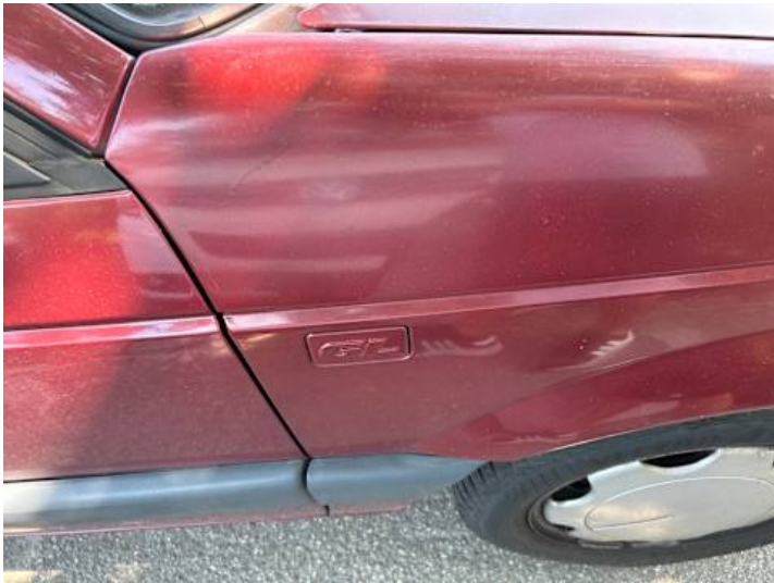
Kotflügel vorne rechts (Unsachgemäß instand gesetzt)
