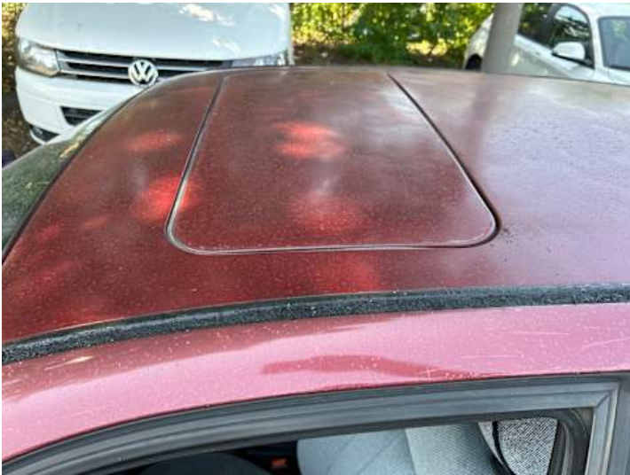
Dach (Unsachgemäß instand gesetzt)
