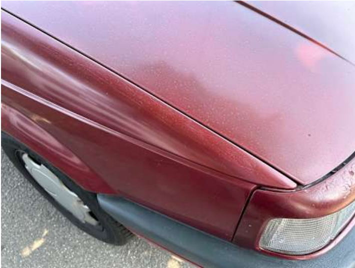
Kotflügel vorne rechts (Unsachgemäß instand gesetzt)
