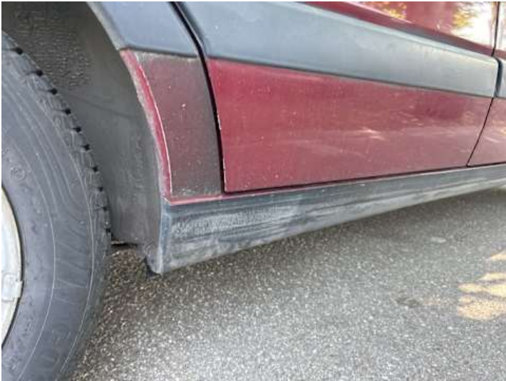
Schweller rechts (Unsachgemäß instand gesetzt)
