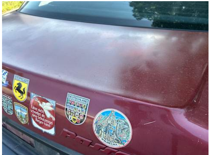
Heckklappe (Unsachgemäß instand gesetzt, Ausgeblichen/Matt)
