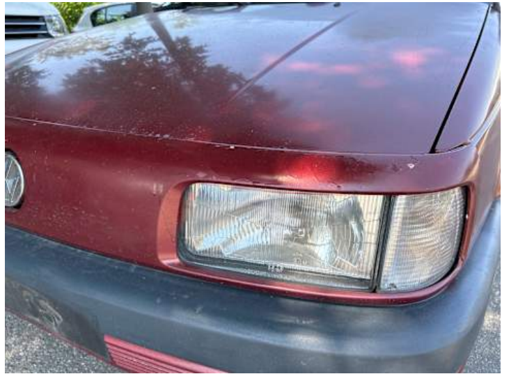
Stoßstange vorne (Unsachgemäß instand gesetzt)
