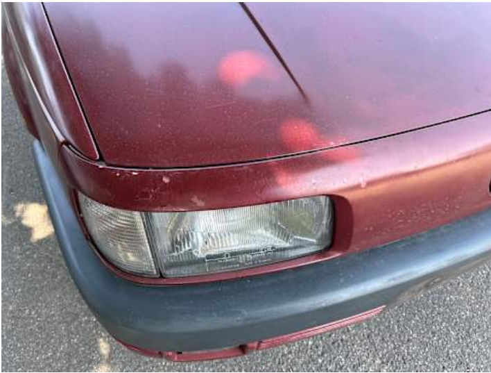
Stoßstange vorne (Unsachgemäß instand gesetzt)
