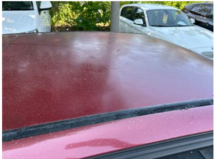
Dach (Unsachgemäß instand gesetzt)
