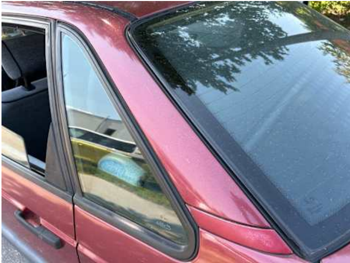
Seitenteil hinten links (Unsachgemäß instand gesetzt)
