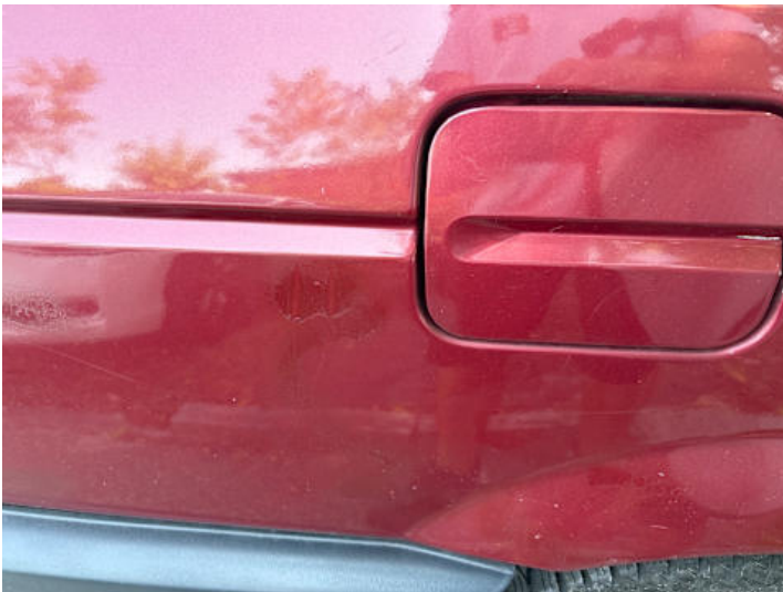
Seitenteil hinten rechts (Unsachgemäß instand gesetzt)
