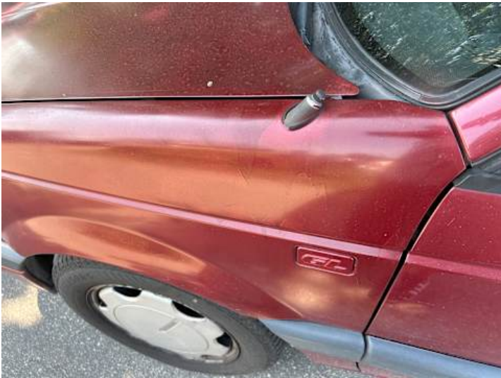
Kotflügel vorne links (Unsachgemäß instand gesetzt)
