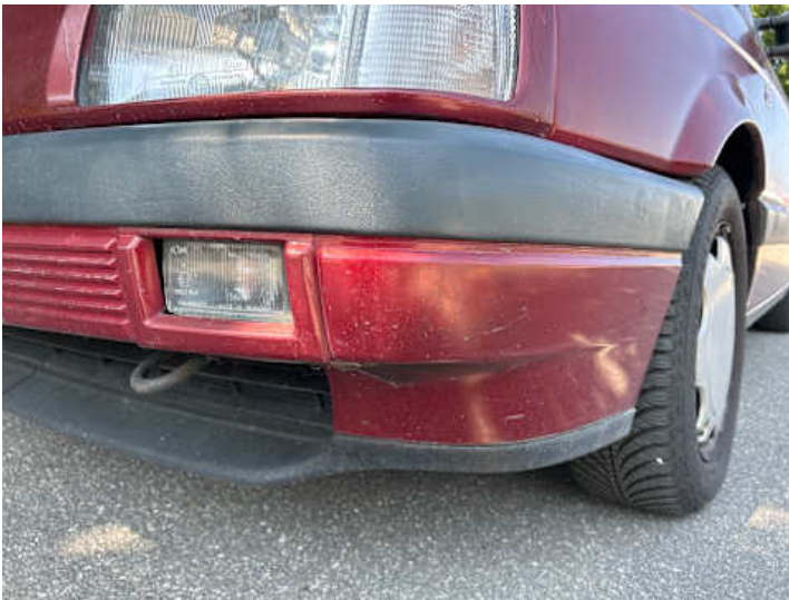
Stoßstange vorne (Unsachgemäß instand gesetzt)
