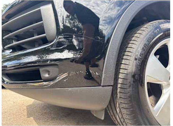
Stoßstange vorne (Lackschaden, Kratzer)
