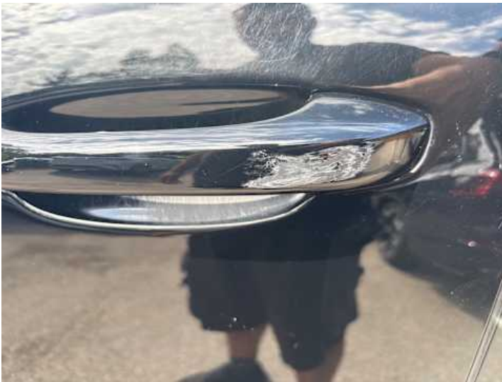
Fahrertür (Kratzer, Lackschaden)
