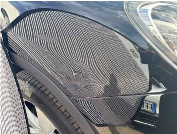
Kotflügel vorne rechts (Lackschaden, Kratzer, Unsachgemäß instand gesetzt, Delle)
