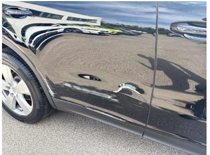
Türe hinten rechts (Lackschaden, Kratzer, Verformung)
