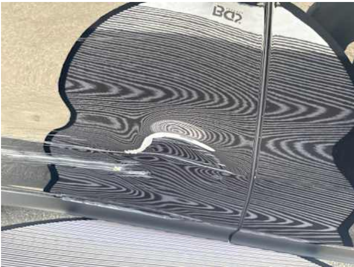
Türe hinten rechts (Lackschaden, Kratzer, Verformung)
