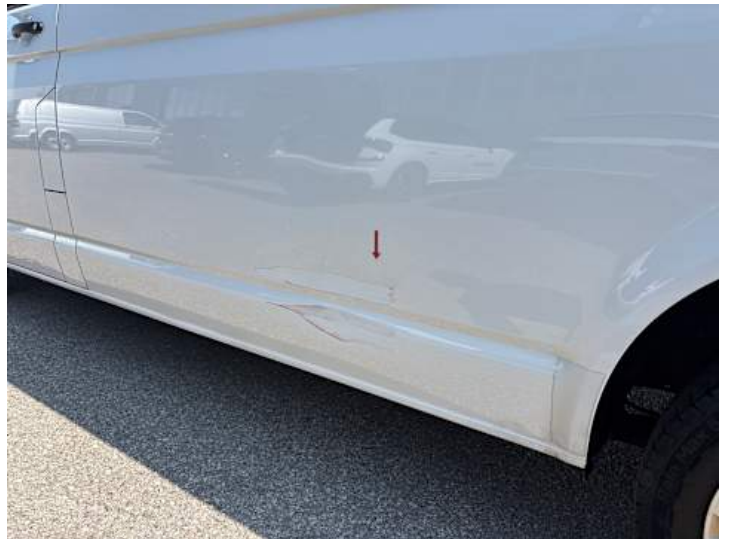
Seitenteil hinten links (Verformung, Kratzer, Lackschaden)
