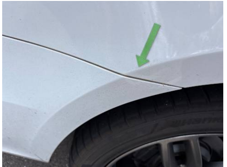
Seitenteil hinten rechts (Spaltmaße ungenau)
