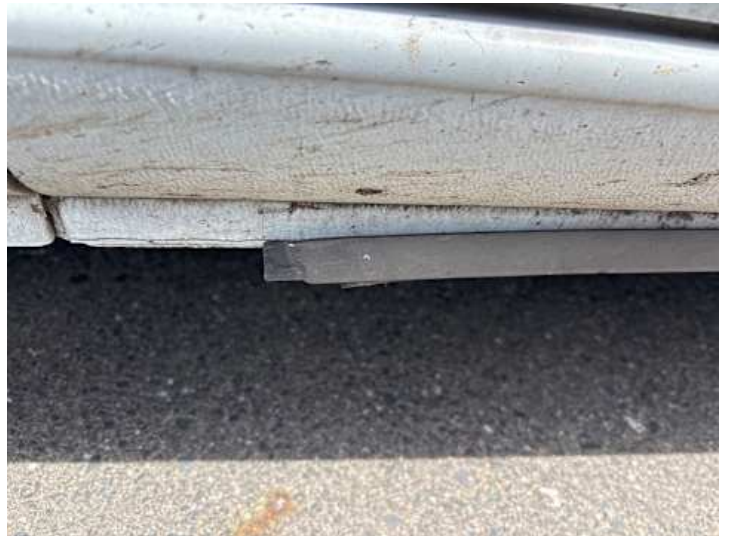
Schweller links (Anderer Schaden): Schutzleiste lose
