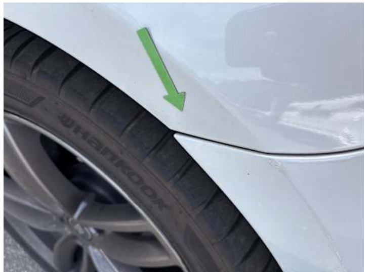
Kotflügel vorne rechts (Spaltmaße ungenau)
