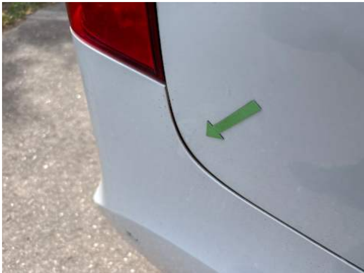
Seitenteil hinten rechts (Spaltmaße ungenau)
