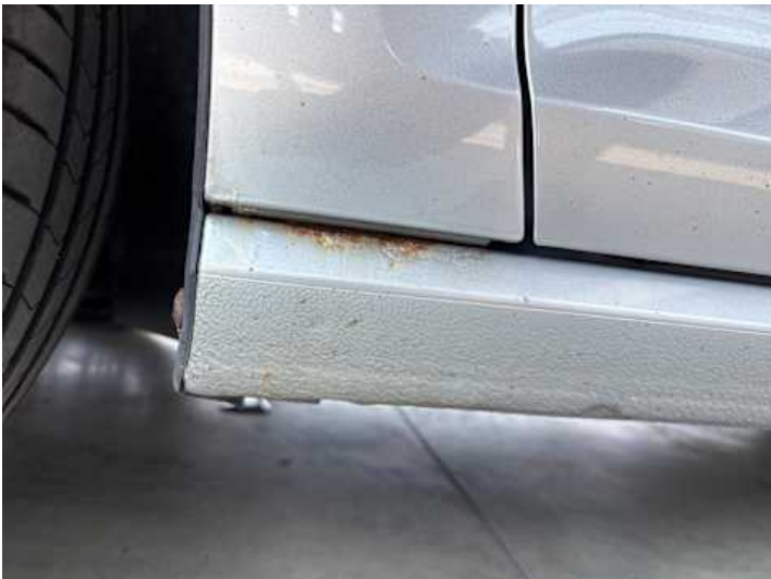
Schweller links (Rost)
