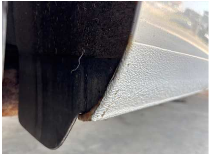
Schweller rechts (Rost)
