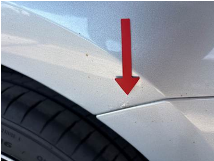
Seitenteil hinten links (Rost)
