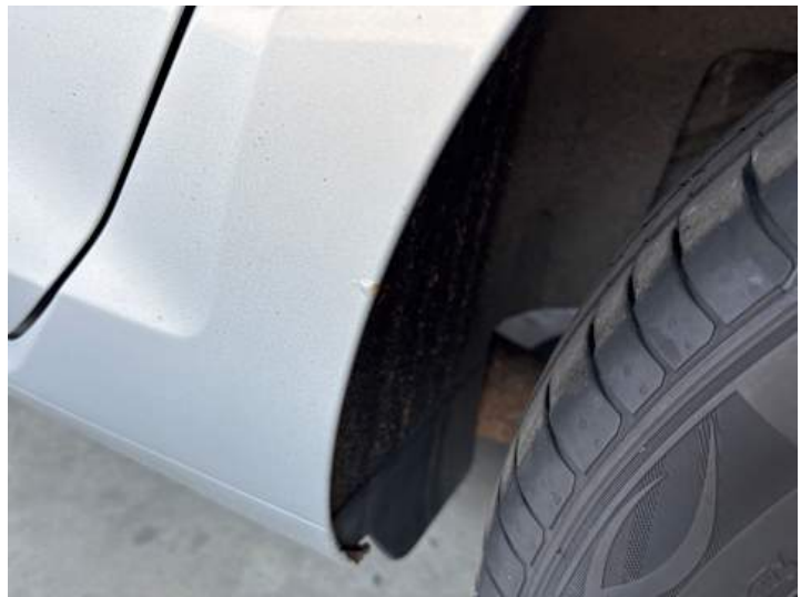
Seitenteil hinten links (Rost)
