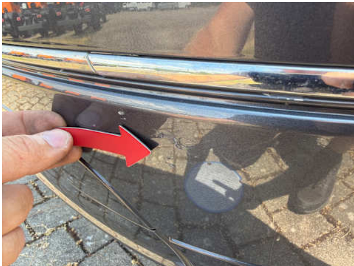
Stoßstange hinten (Riss/Bruch)
