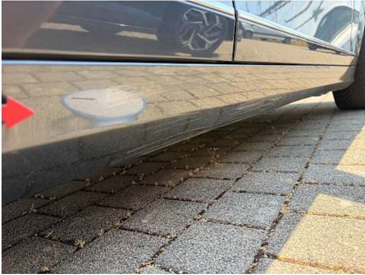
Schweller rechts (Kratzer, Delle)
