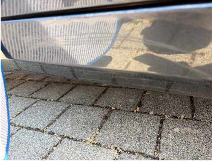
Schweller rechts (Kratzer, Delle)
