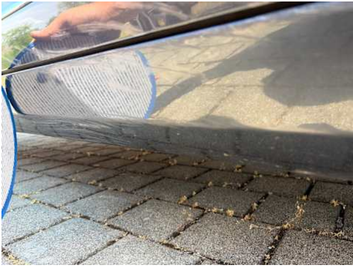
Schweller rechts (Kratzer, Delle)
