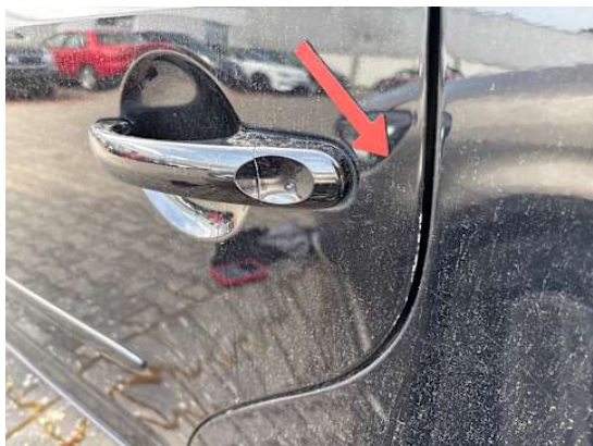
Türe hinten links (Lackschaden)
