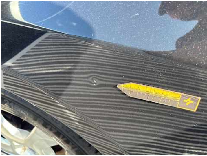
Kotflügel vorne links (Delle)
