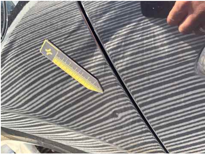
Seitenteil hinten rechts (Delle)
