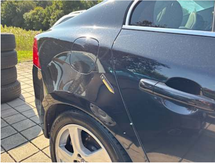
Seitenteil hinten rechts (Delle)
