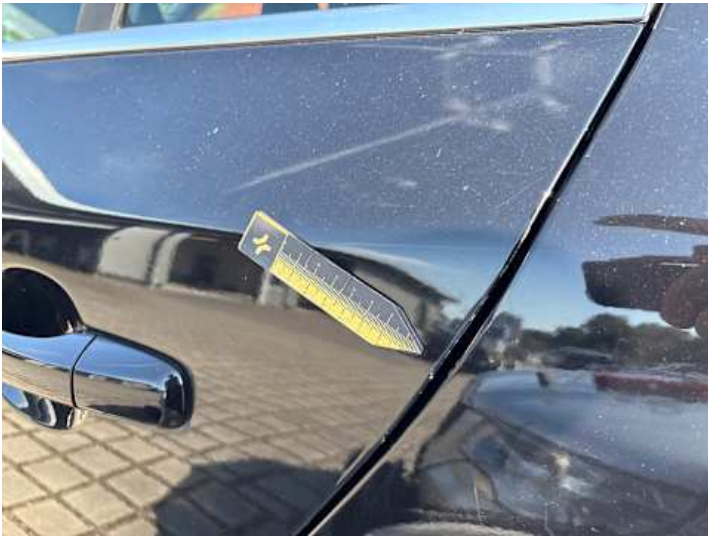
Türe hinten links (Kratzer)
