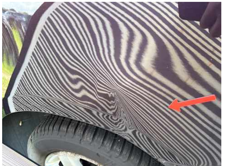
Seitenteil hinten links (Verformung)
