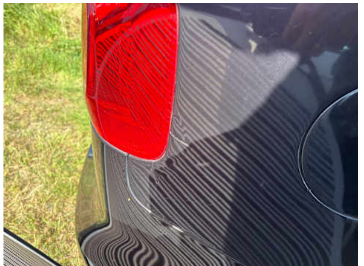
Seitenteil hinten rechts (Unsachgemäß instand gesetzt)
