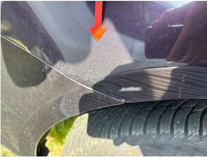
Seitenteil hinten rechts (Unsachgemäß instand gesetzt)
