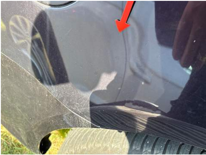
Seitenteil hinten rechts (Unsachgemäß instand gesetzt)
