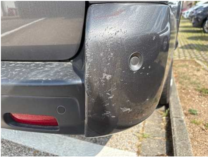
Stoßstange hinten (Lackschaden, Riss/Bruch)
