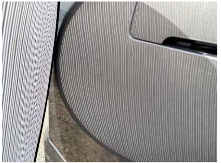
Seitenteil hinten rechts (Delle, Verformung)
