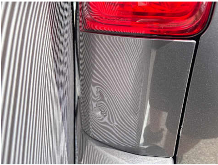
Seitenteil hinten links (Delle, Kratzer)
