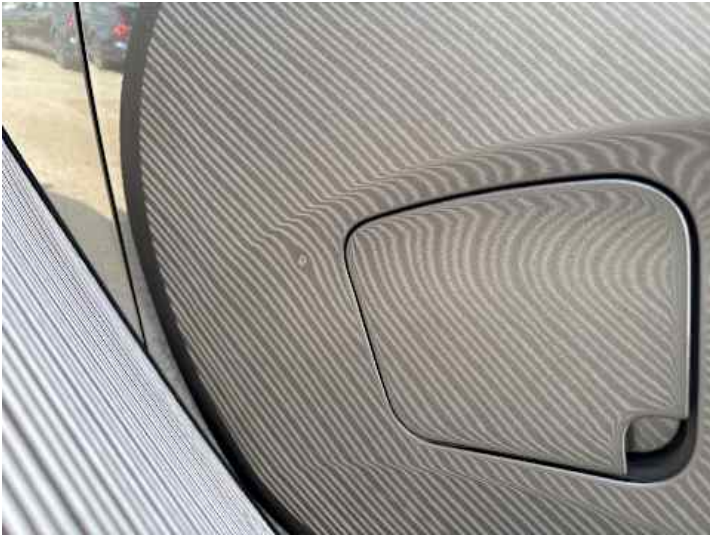
Seitenteil hinten links (Delle)
