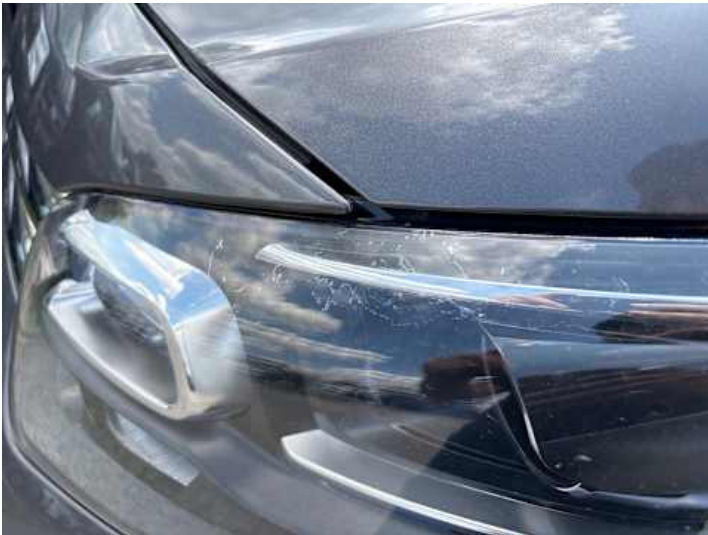
Scheinwerfer (links) (Anderer Schaden): Lackschaden
