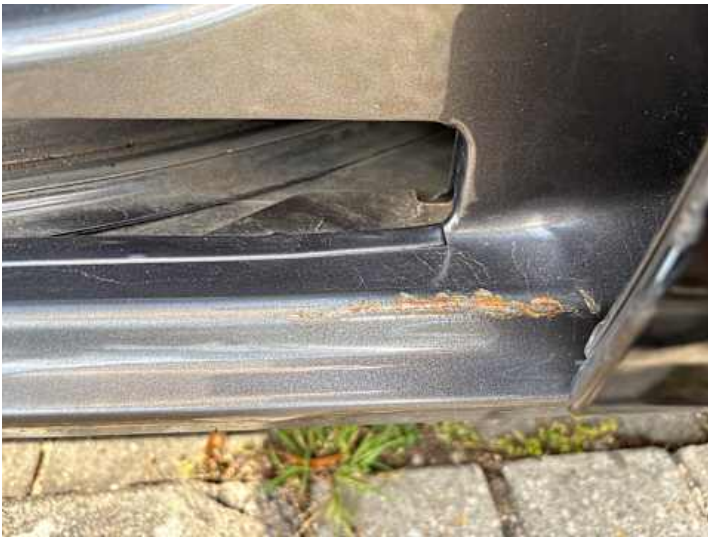
Türe hinten rechts (Rost)
