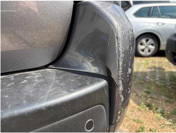
Stoßstange hinten (Lackschaden, Riss/Bruch)
