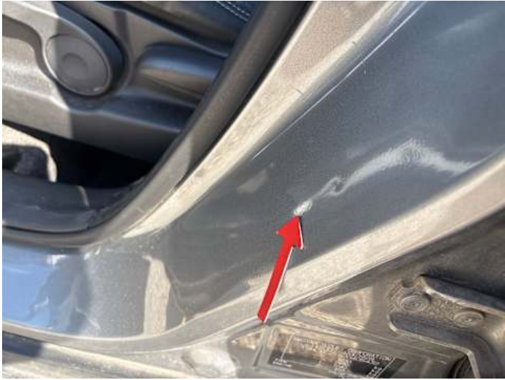
Schweller links (Delle)
