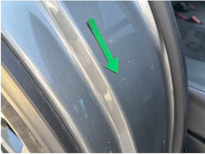
Seitenteil hinten rechts (Kratzer)
