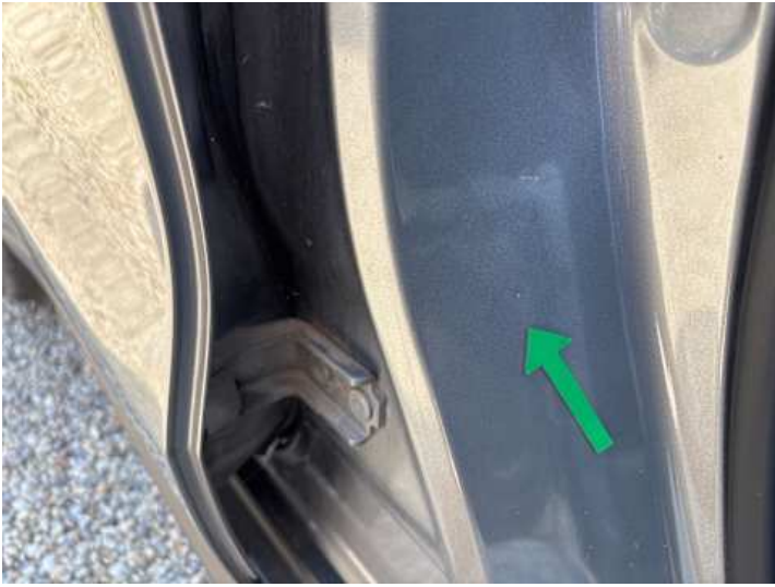
Schweller rechts (Kratzer, Delle)
