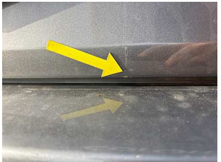
Heckklappe (Kratzer, Rost)
