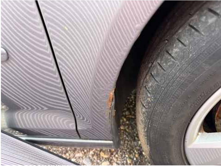
Kotflügel vorne rechts (Rost)
