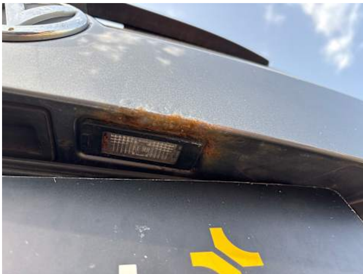
Heckklappe (Kratzer, Rost)
