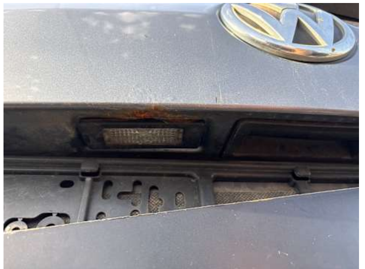
Heckklappe (Kratzer, Rost)
