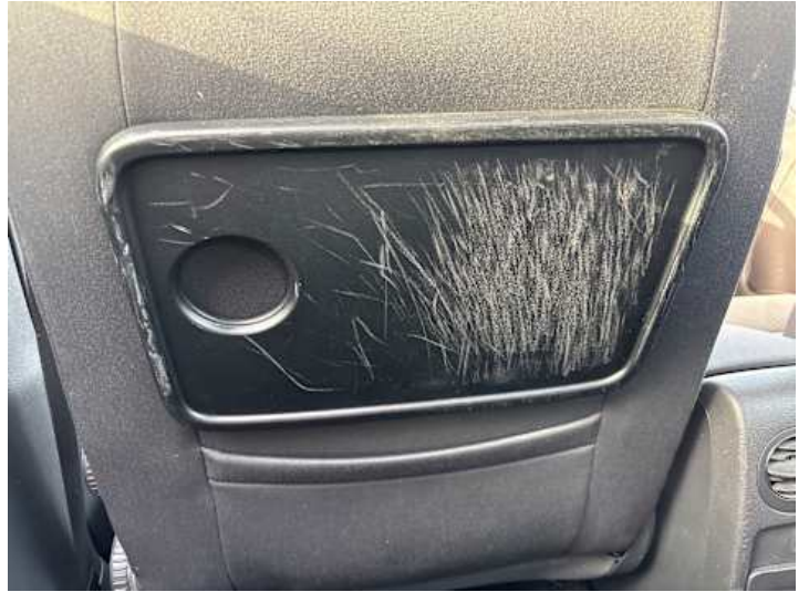
Innenraum (Kratzer, Riss/Bruch)
