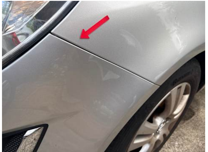
Stoßstange vorne (Spaltmaße ungenau)
