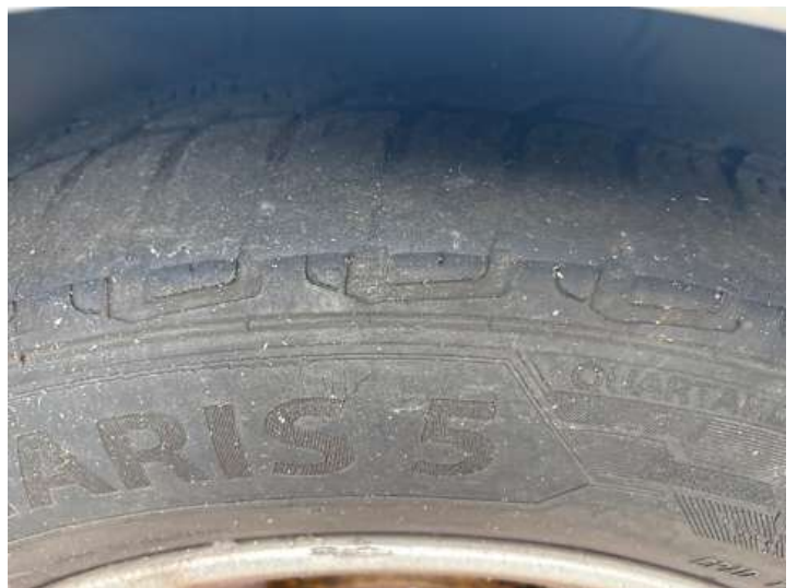
Rad (Ungleichmäßig abgefahren)
