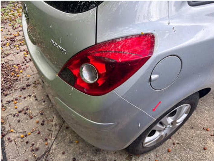
Stoßstange hinten (Spaltmaße ungenau)
