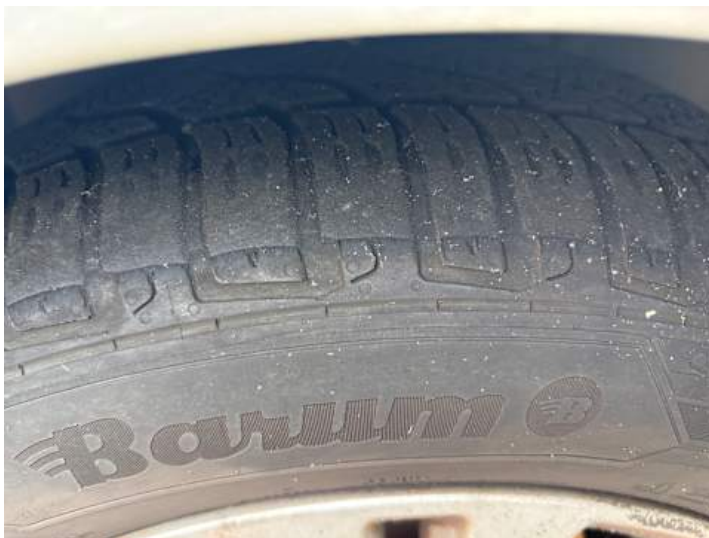
Rad (Ungleichmäßig abgefahren)
