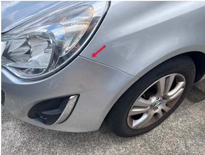
Stoßstange vorne (Spaltmaße ungenau)
