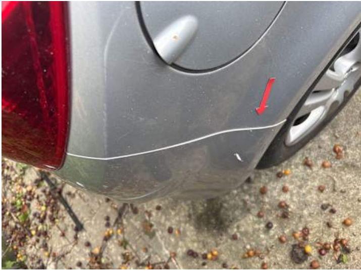
Stoßstange hinten (Spaltmaße ungenau)
