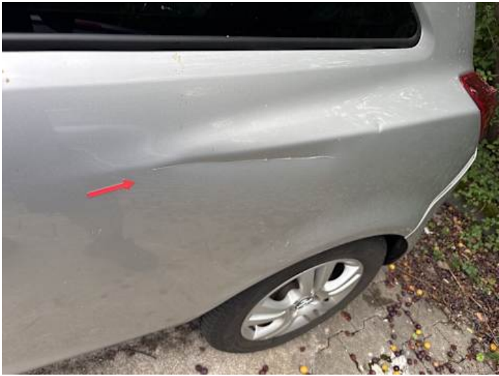
Seitenteil hinten links (Lackschaden, Verformung)
