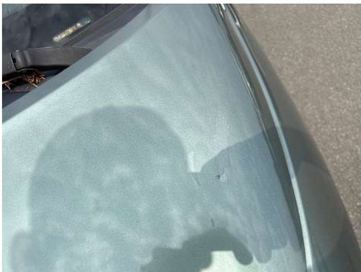
Motorhaube (Lackschaden, Kratzer)
