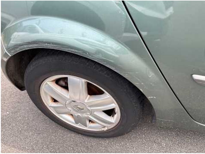
Seitenteil hinten rechts (Kratzer, Verformung)
