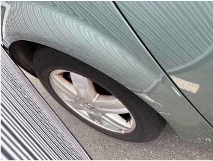
Seitenteil hinten rechts (Kratzer, Verformung)
