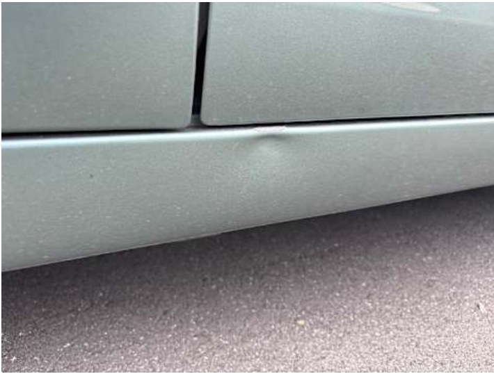
Schweller rechts (Verformung)
