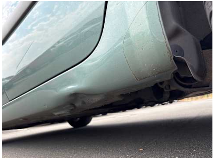
Schweller links (Verformung)
