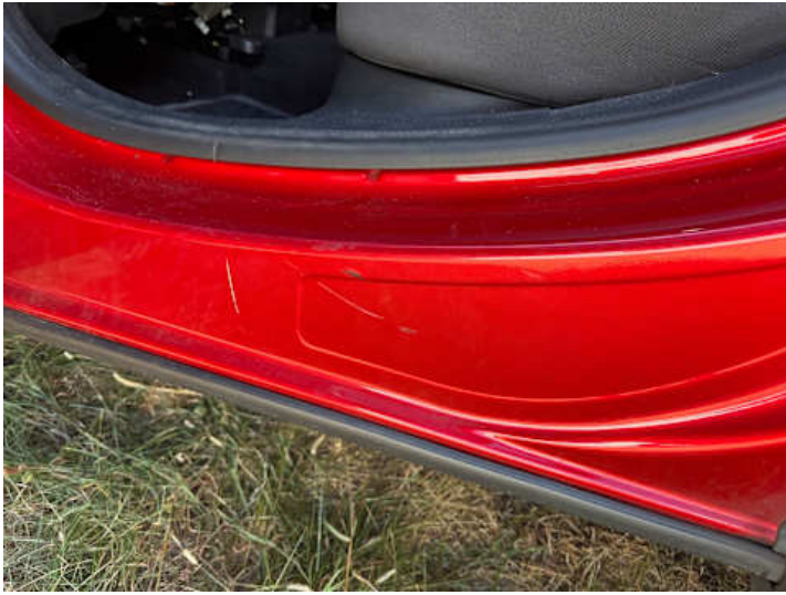
Schweller links (Lackschaden)
