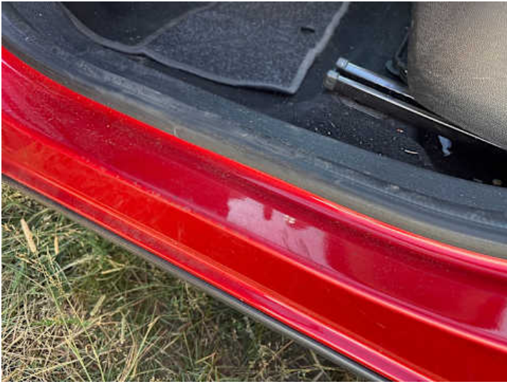
Schweller links (Lackschaden)
