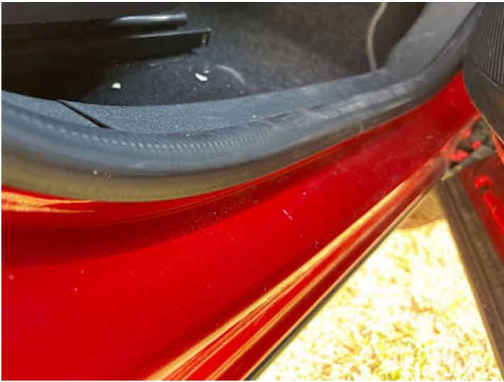
Schweller rechts (Lackschaden)
