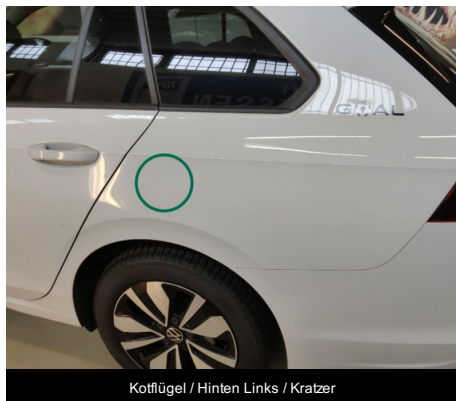
Kotflügel / Hinten Links / Kratzer
