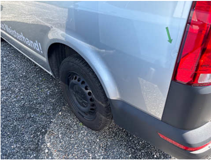
Seitenteil hinten links (Kratzer, Delle)
