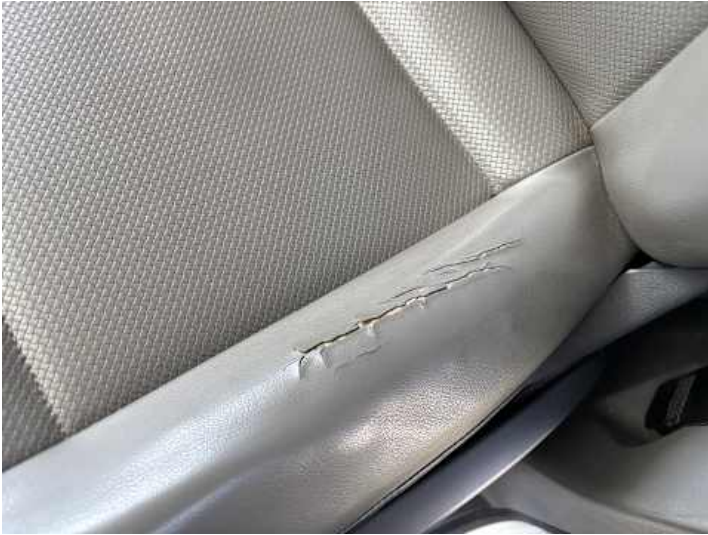
Innenraum (Verschleiß, Riss/Bruch)
