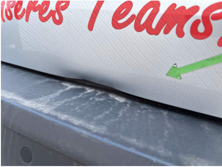
Heckklappe (Verformung, Lackschaden)
