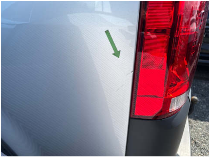
Seitenteil hinten links (Kratzer, Delle)
