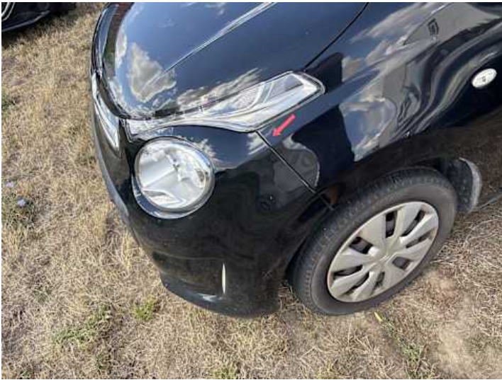
Stoßstange vorne (Spaltmaße ungenau)
