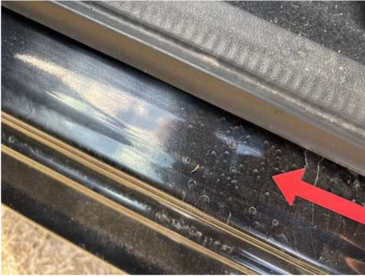
Schweller links (Rost)
