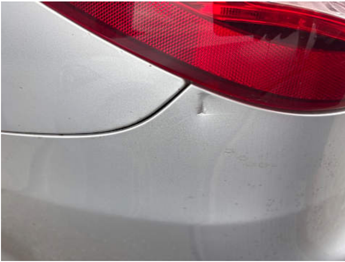
Stoßstange hinten (Kratzer, Unsachgemäß instand gesetzt, Delle)
