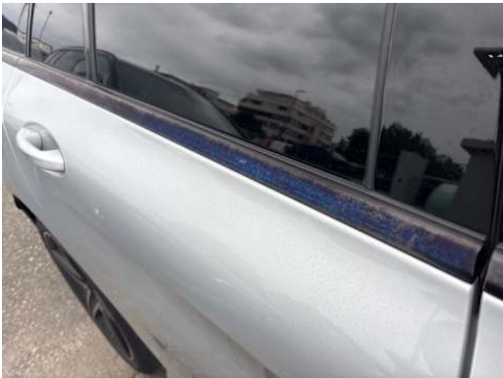
Türe hinten rechts (Lackschaden)
