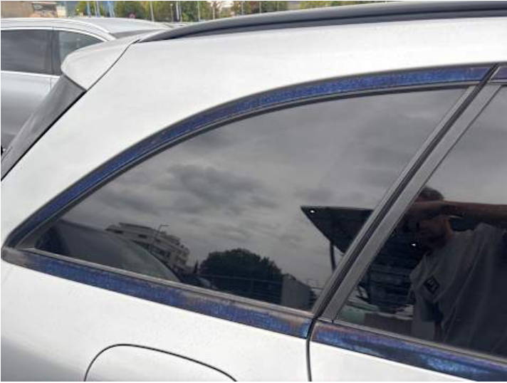
Seitenteil hinten rechts (Lackschaden)
