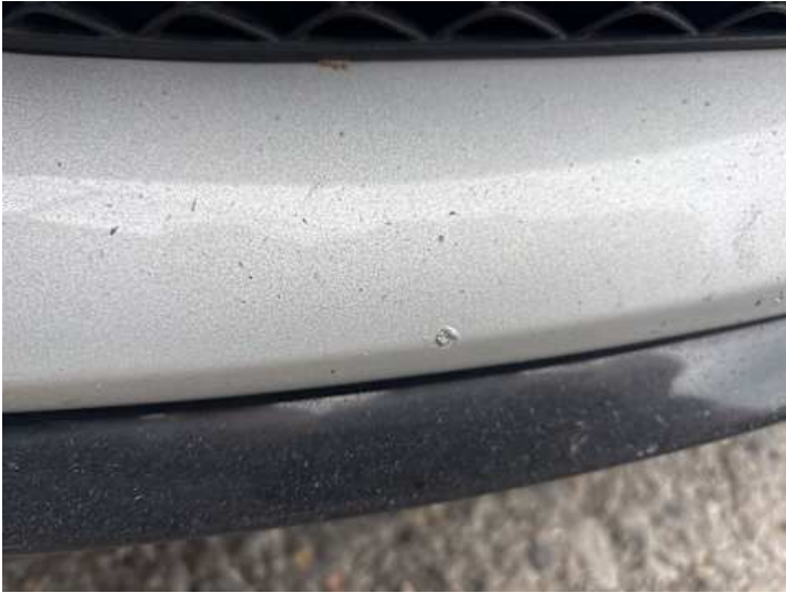
Stoßstange vorne (Steinschlag, Kratzer, Unsachgemäß instand gesetzt)
