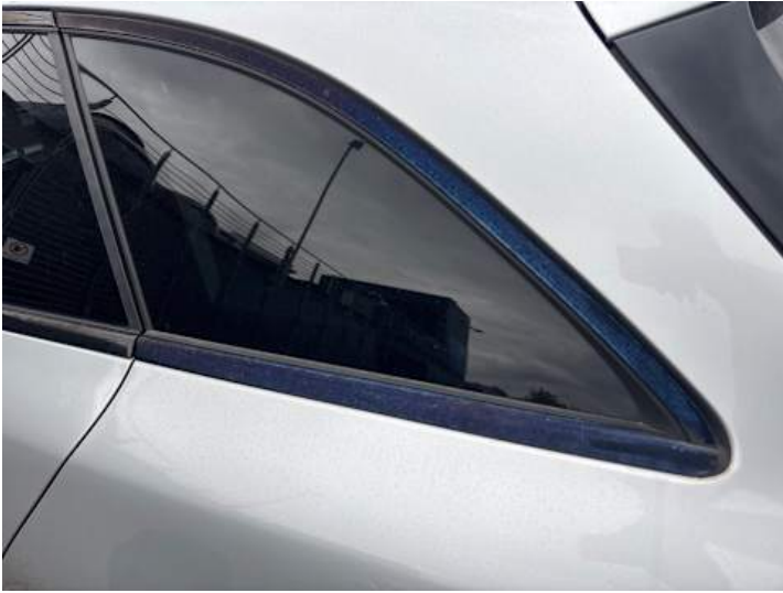
Seitenteil hinten links (Lackschaden)
