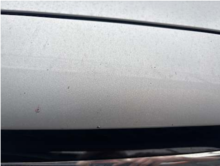
Stoßstange vorne (Steinschlag, Kratzer, Unsachgemäß instand gesetzt)
