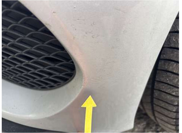
Stoßstange vorne (Steinschlag, Kratzer, Unsachgemäß instand gesetzt)
