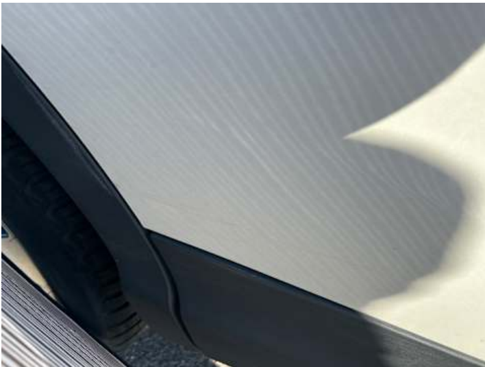
Türe hinten rechts (Verformung, Kratzer)
