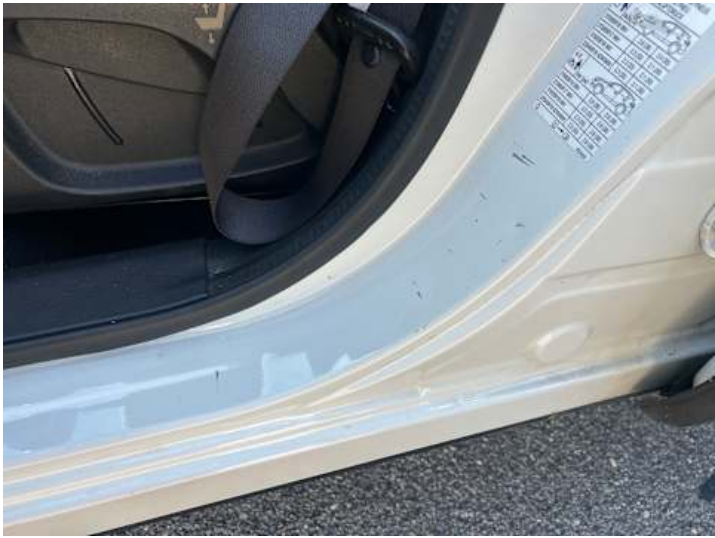
Schweller links (Kratzer, Delle)
