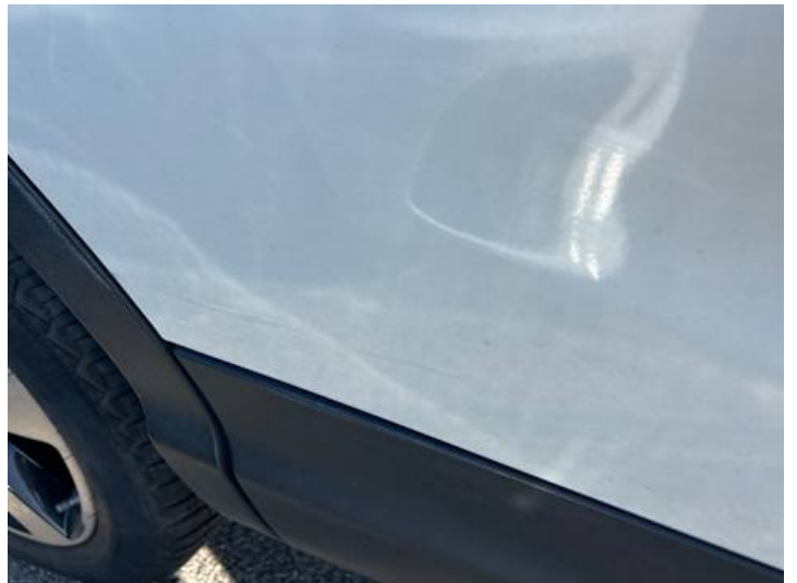
Türe hinten rechts (Verformung, Kratzer)
