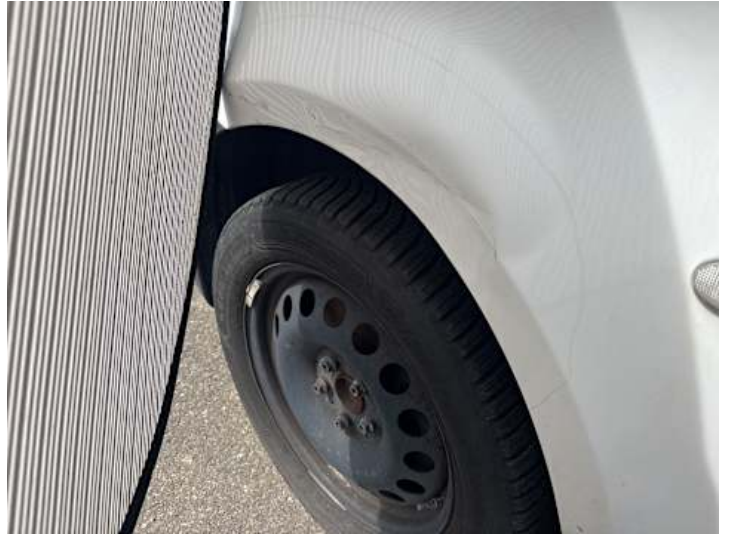
Kotflügel vorne links (Verformung, Kratzer)
