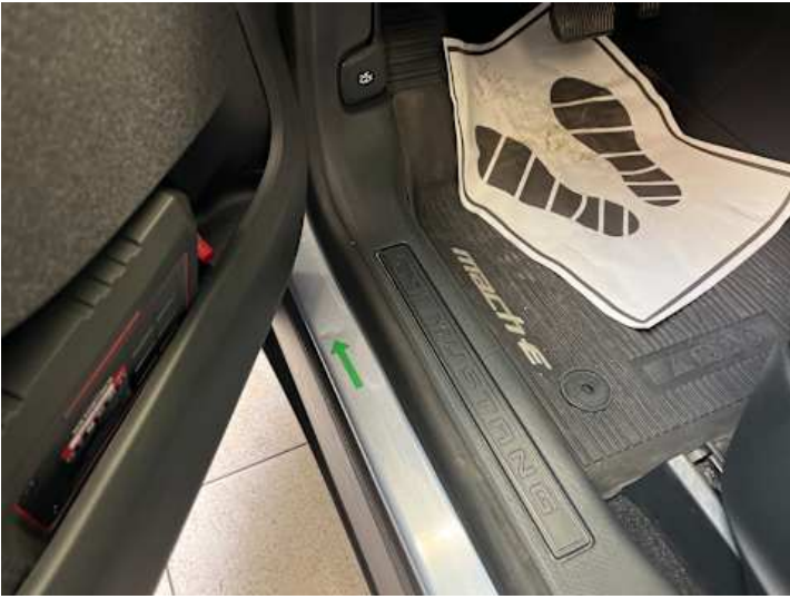
Schweller links (Delle)
