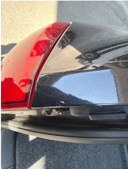
Seitenteil hinten links (Rost)
