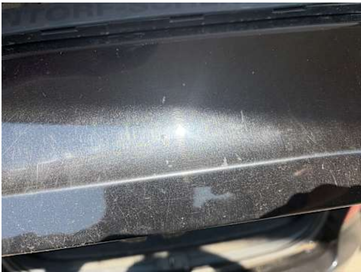
Heckklappe (Kratzer, Lackschaden)
