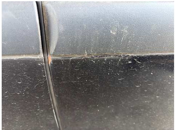
Türe hinten links (Rost)
