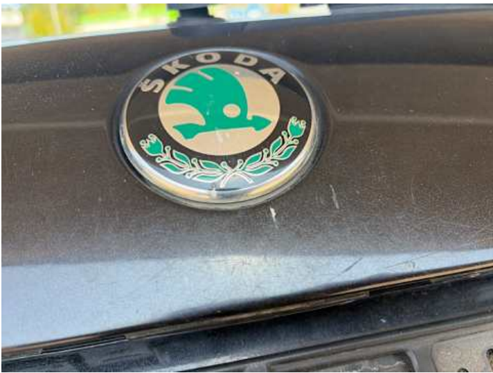
Heckklappe (Kratzer, Lackschaden)
