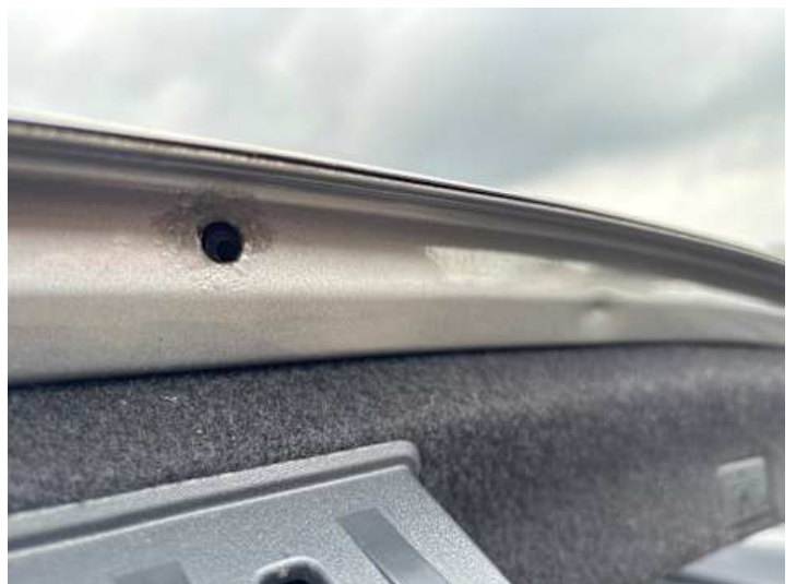
Heckklappe (Rost, Lackschaden, Delle)
