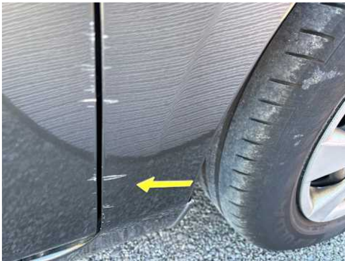
Kotflügel vorne rechts (Lackschaden, Kratzer)
