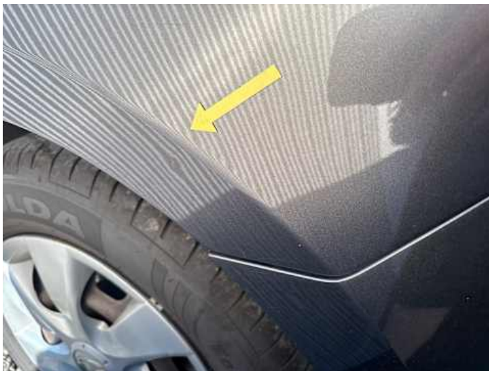
Seitenteil hinten links (Delle)
