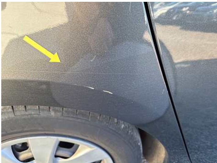
Seitenteil hinten rechts (Lackschaden, Kratzer)
