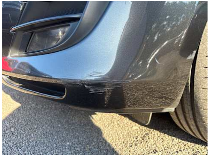
Stoßstange vorne (Lackschaden, Kratzer)
