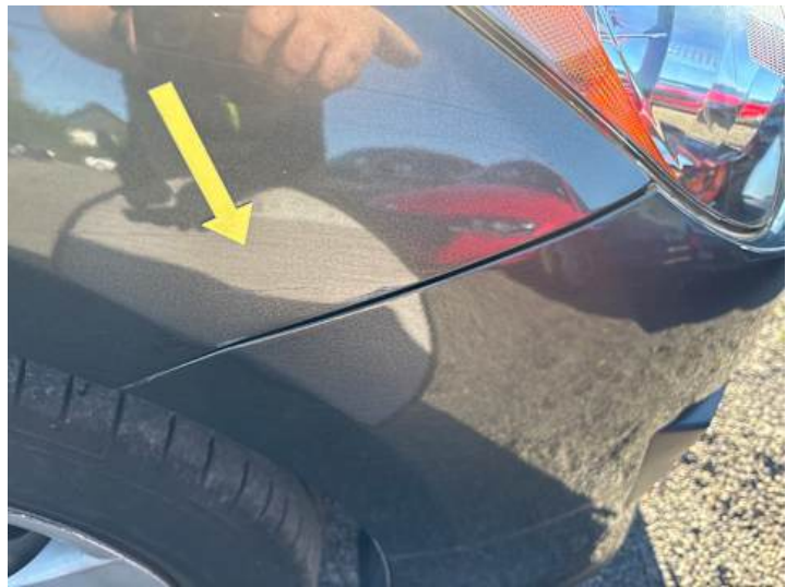
Kotflügel vorne rechts (Lackschaden, Kratzer)
