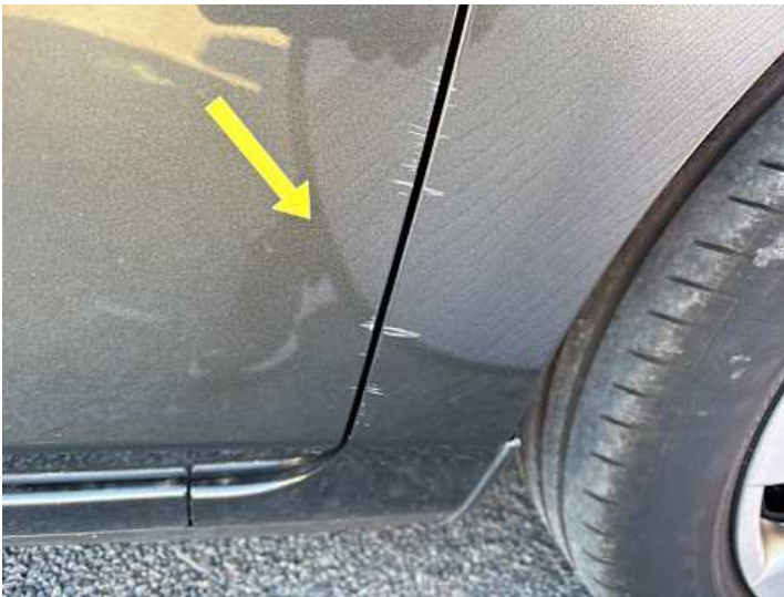
Beifahrertür (Lackschaden, Kratzer)
