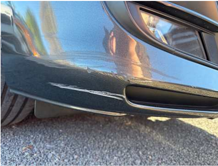
Stoßstange vorne (Lackschaden, Kratzer)
