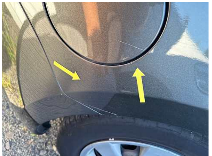
Seitenteil hinten rechts (Lackschaden, Kratzer)
