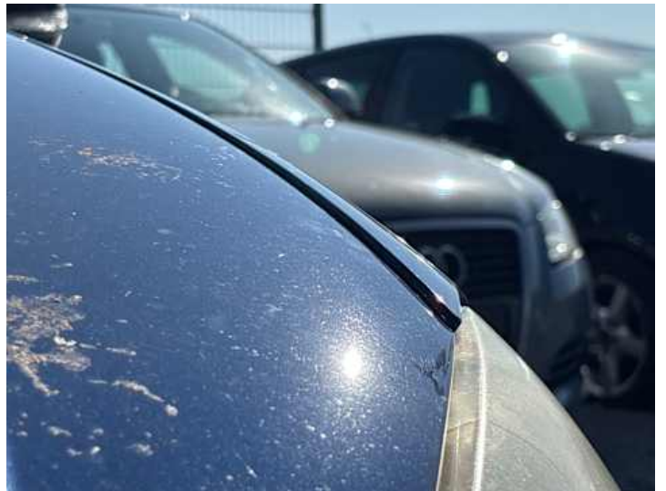
Motorhaube (Spaltmaße ungenau)
