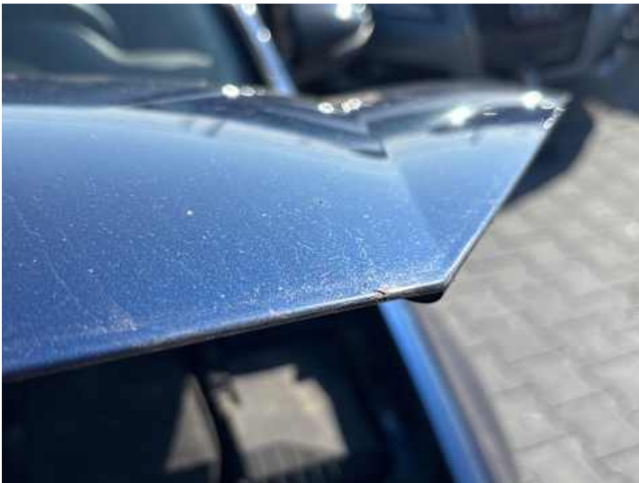
Motorhaube (Rost, Steinschlag)
