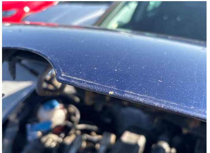
Motorhaube (Rost, Steinschlag)
