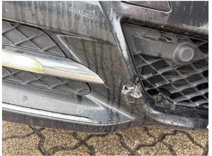
Stoßstange vorne (Riss/Bruch)
