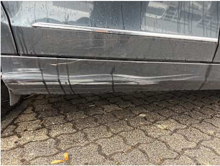
Schweller rechts (Kratzer, Verformung)
