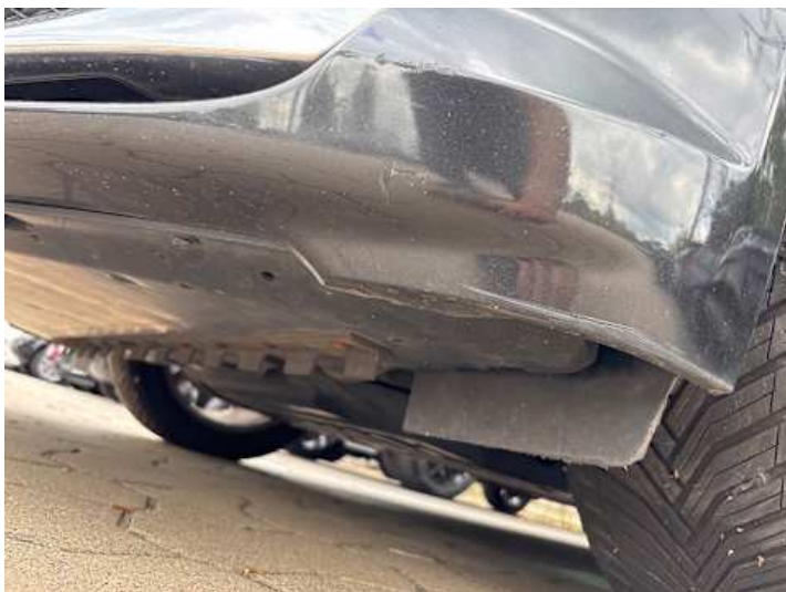
Stoßstange vorne (Kratzer, Lackschaden)
