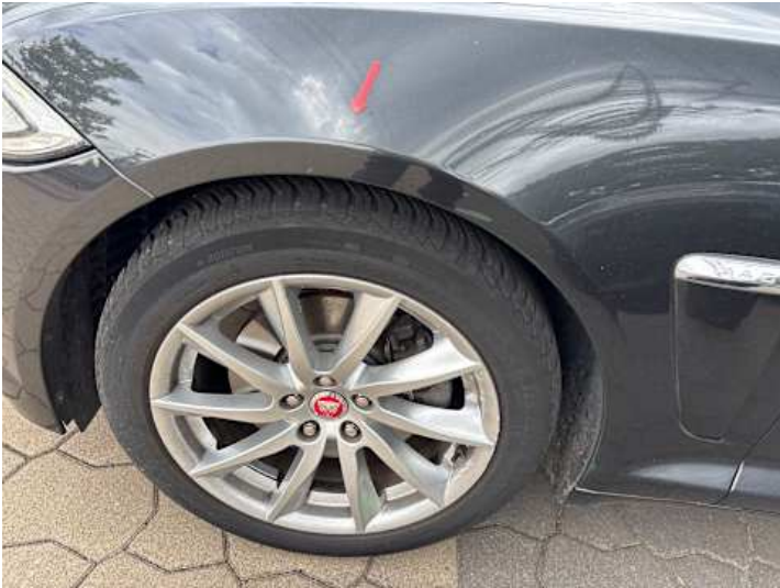
Kotflügel vorne links (Kratzer)
