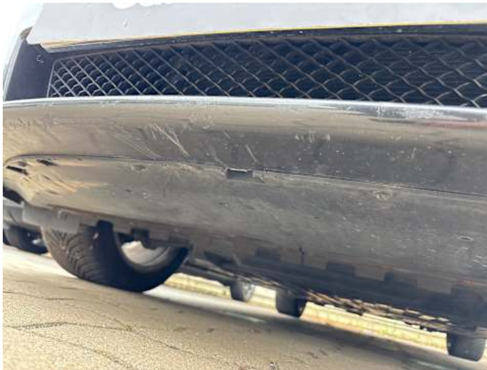
Stoßstange vorne (Kratzer, Lackschaden)
