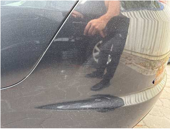
Stoßstange hinten (Kratzer)
