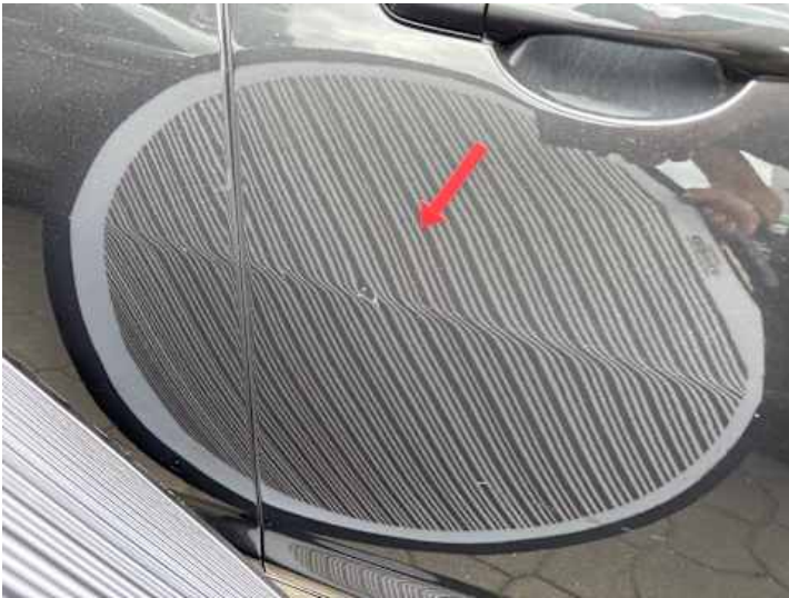
Beifahrtür (Kratzer, Delle)
