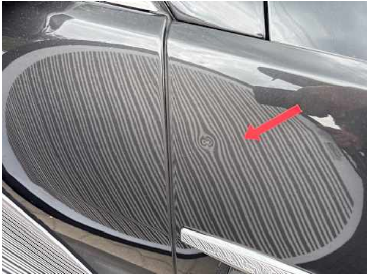
Kotflügel vorne rechts (Kratzer, Delle)
