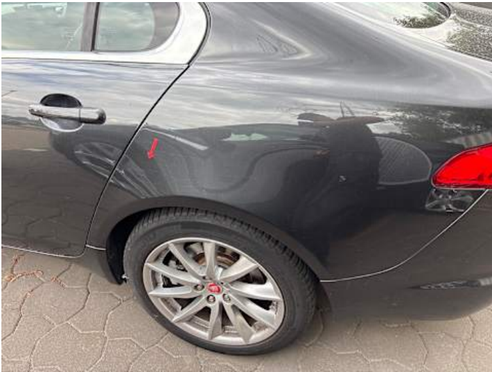
Seitenteil hinten links (Delle)
