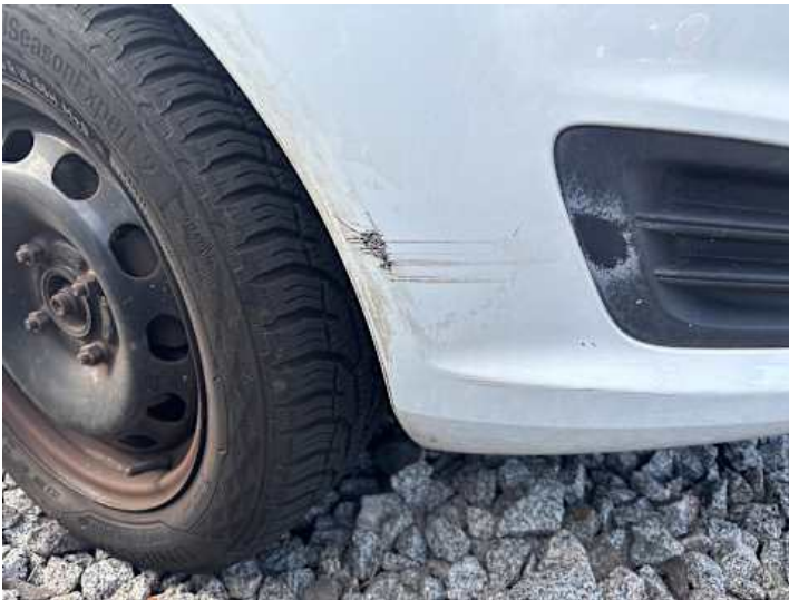
Stoßstange vorne (Kratzer, Lackschaden)
