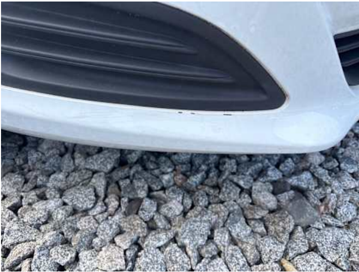
Stoßstange vorne (Kratzer, Lackschaden)
