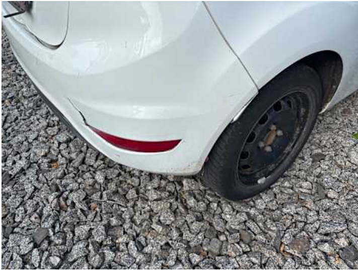
Stoßstange hinten (Lackschaden)
