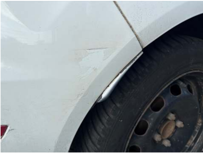
Stoßstange hinten (Lackschaden)
