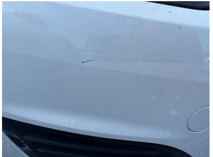
Stoßstange vorne (Kratzer, Lackschaden)
