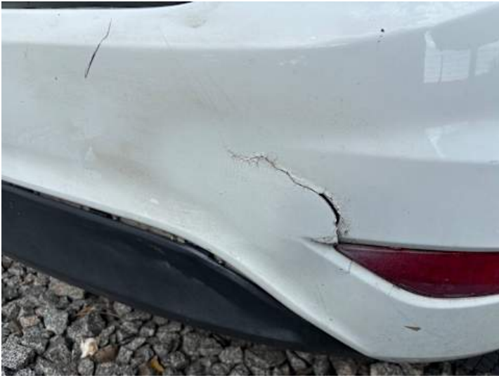
Stoßstange hinten (Riss/Bruch, Verformung, Spaltmaße ungenau)
