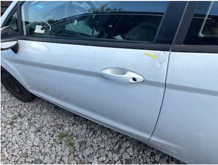
Fahrtür (Lackschaden, Delle, Rost)
