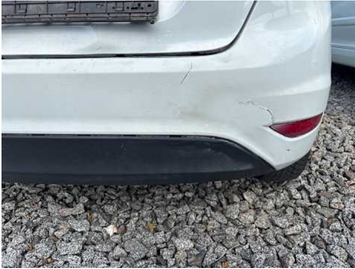
Stoßstange hinten (Riss/Bruch, Verformung, Spaltmaße ungenau)
