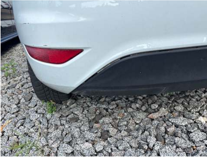
Stoßstange hinten (Riss/Bruch, Verformung, Spaltmaße ungenau)
