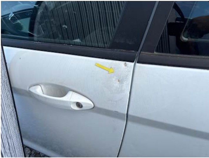
Fahrtür (Lackschaden, Delle, Rost)
