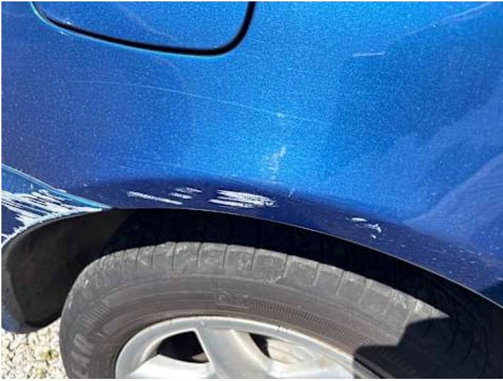
Seitenteil hinten rechts (Lackschaden)
