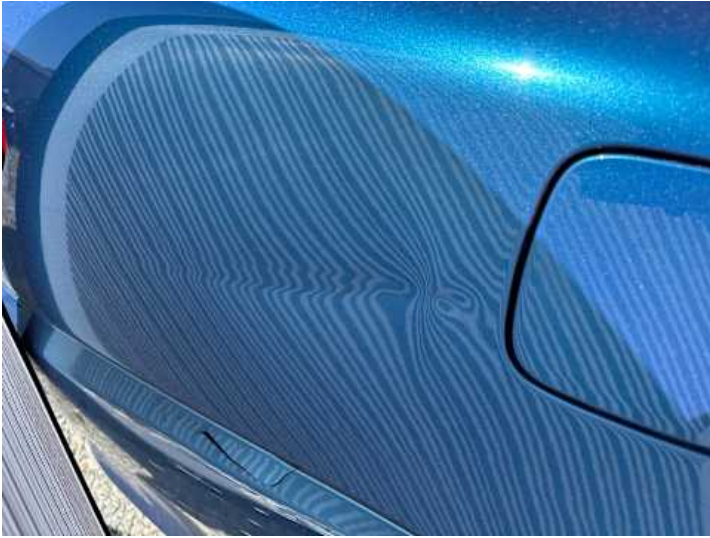
Seitenteil hinten rechts (Verformung)
