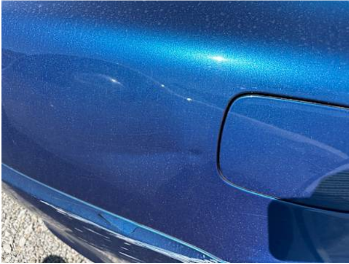
Seitenteil hinten rechts (Verformung)
