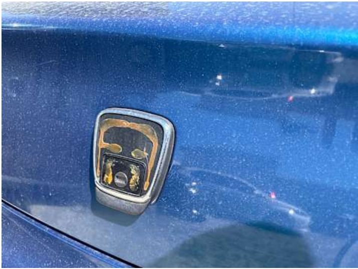
Heckklappe (Anderer Schaden): Emblem fehlt
