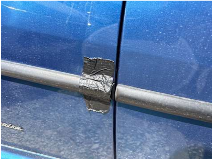
Seitenteil hinten rechts (Riss/Bruch)
