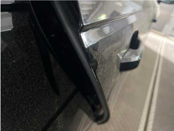
Türe hinten rechts (Lackschaden)
